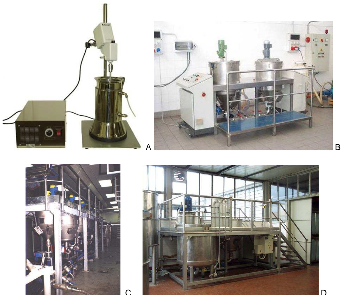
Figure 45 : (A) réacteur d'extraction assistée par ultrason de 3L, (B) équipement à l'échelle pilote : cuve de 50 L et (C et D) équipement à l'échelle industrielle : cuves de 500 et 1000 L
