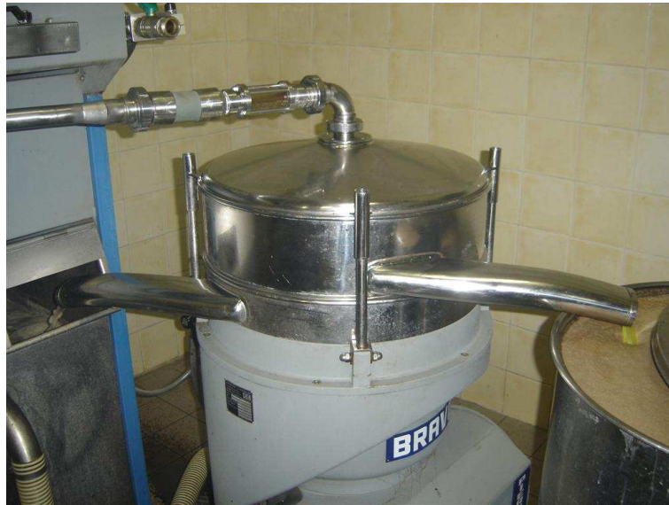
Figure 14 : Centrifugeuse. A droite sortie de l'huile d'olive, à gauche sortie des margines
