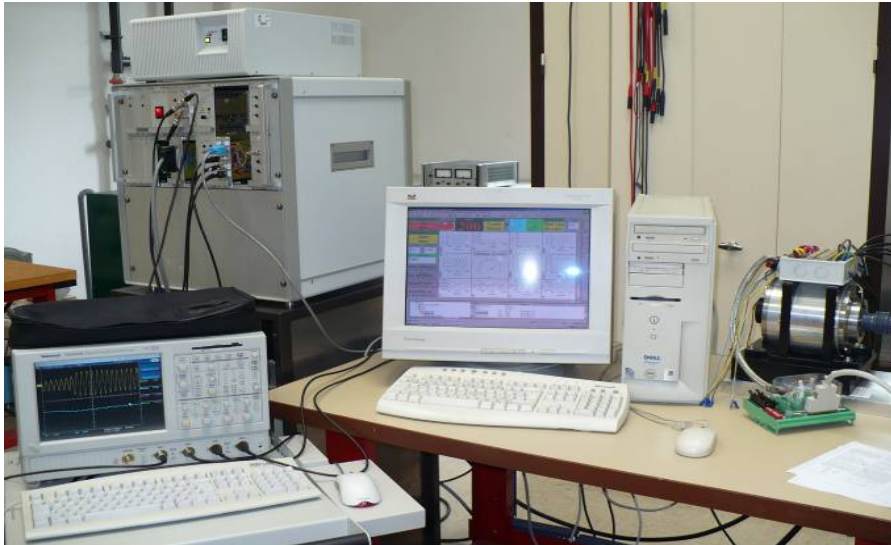
Figure II -4 : Le banc d'essais comprenant le moteur, l'onduleur et le système de commande (dSPACE) ainsi que les organes de mesure et d'acquisition.
