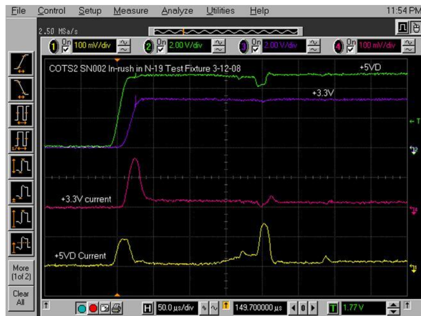
Figure 4-13 : Surconsommation de la carte au démarrage
