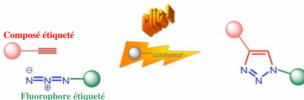
Figure 30 : Schéma de ligation agent pharmacologique-fluorophore par chimie " clic "[132].
