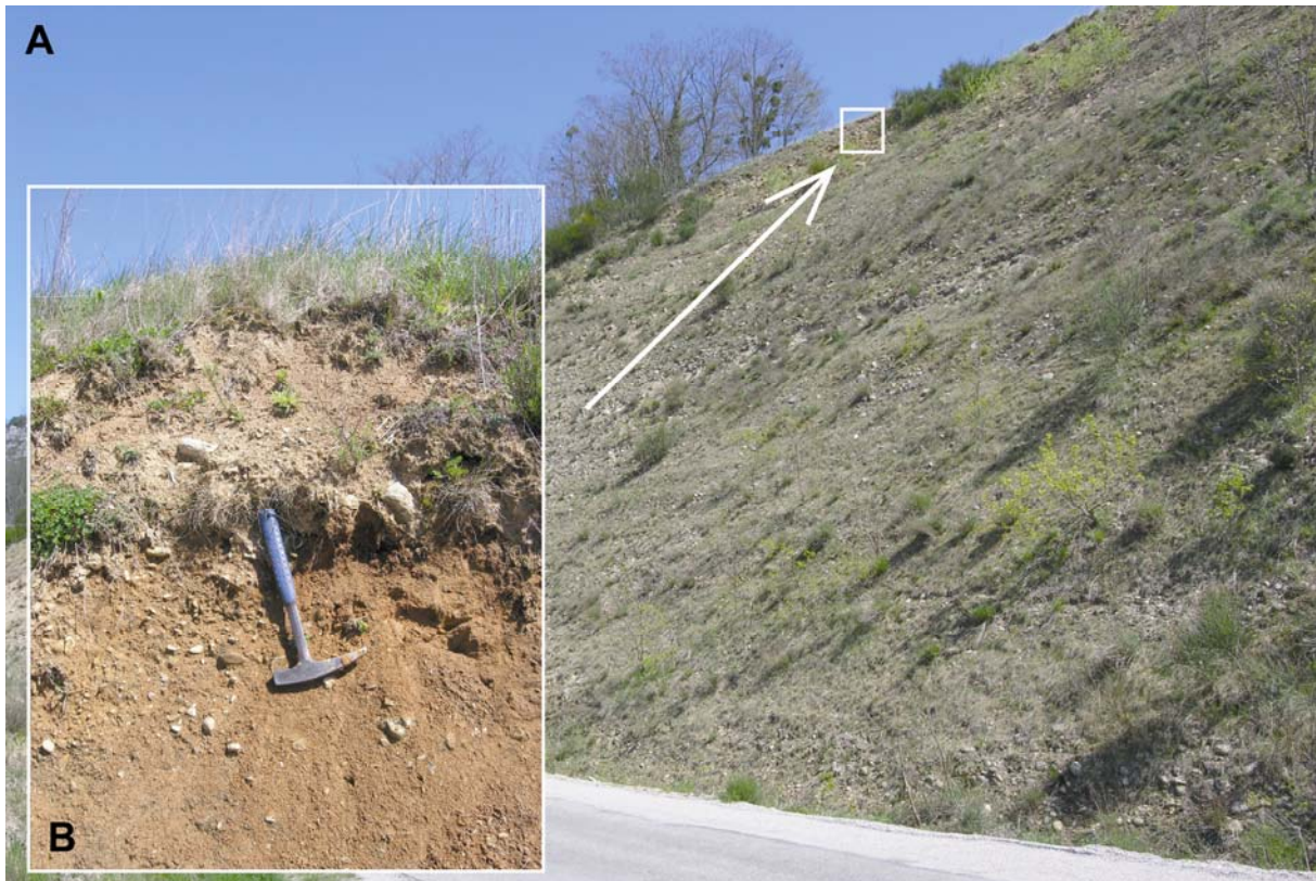
A et B – La Basse Boulbonne (nappe fluvioglacière T2). Coupe accès autoroute Tournac. Noter sur la photo B le sol rouge qui caractérise le toit de cette nappe.
