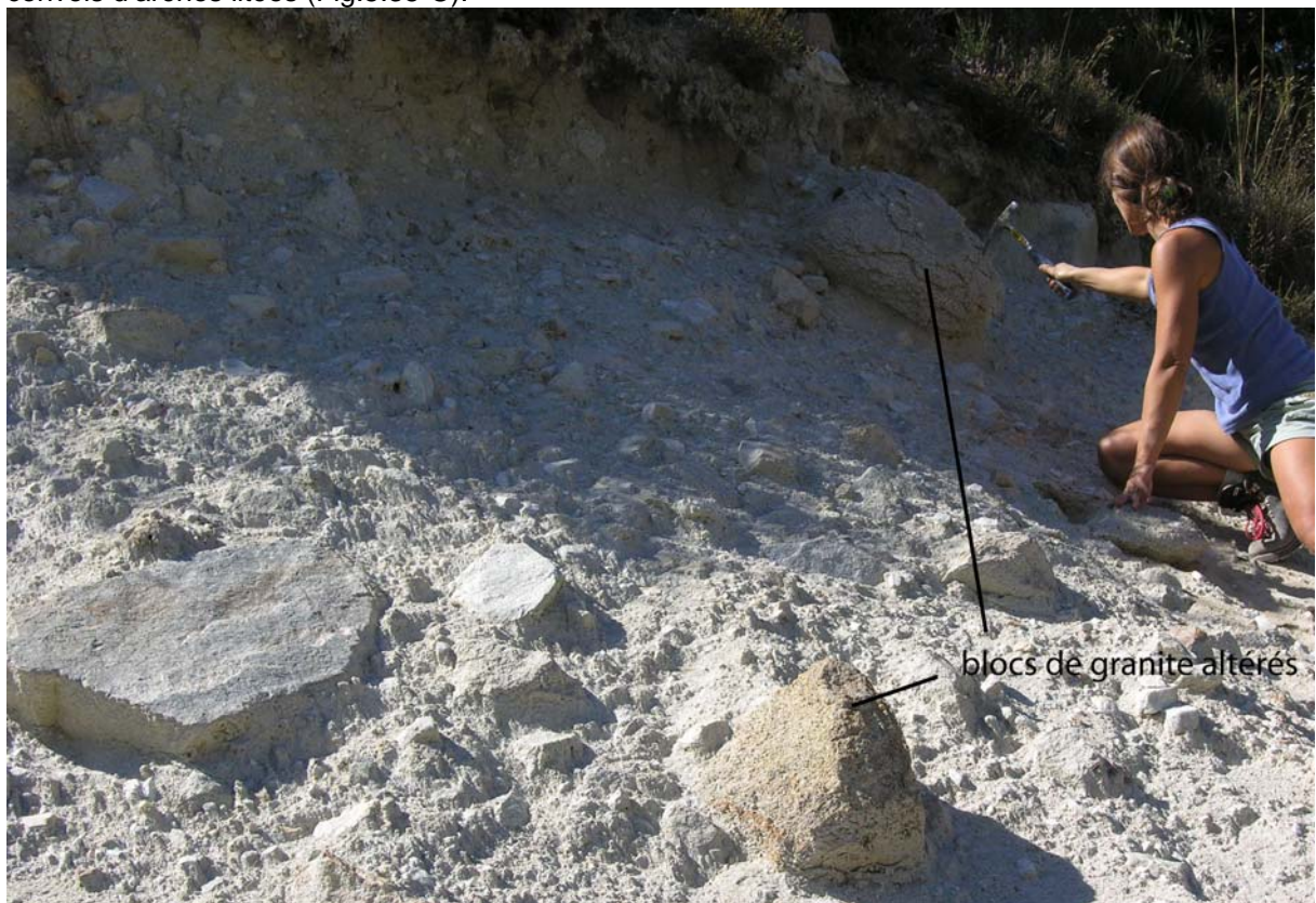
B – Détail de la photo A. Noter le faible état d'altération du till : matrice sablo-limoneuse de teinte grise, blocs et galets de gneiss parfaitement sains. Les blocs de granites altérés sont très probablement remaniés du manteau d'arène qui recouvre le versant.
