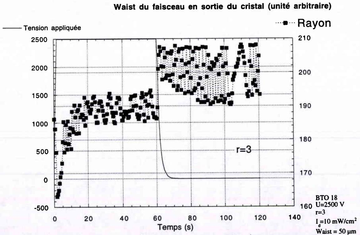
Figure 23 : Mesures brutes pour BTO18, 2000V,  $I_d=10 \text{ mW/cm}^2$ , Waist 50  $\mu\text{m}$
