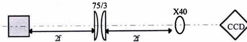
L'observation que nous qualifierons de « directe » est l'observation au microscope de la face de sortie du cristal. Toutefois, il n'est pas possible d'approcher un objectif de microscope de celle-ci, pour des questions d'encombrement. Par ailleurs, la présence d'un fort champ électrique risque de générer des « claquages » entre les électrodes et la partie métallique de l'objectif.
