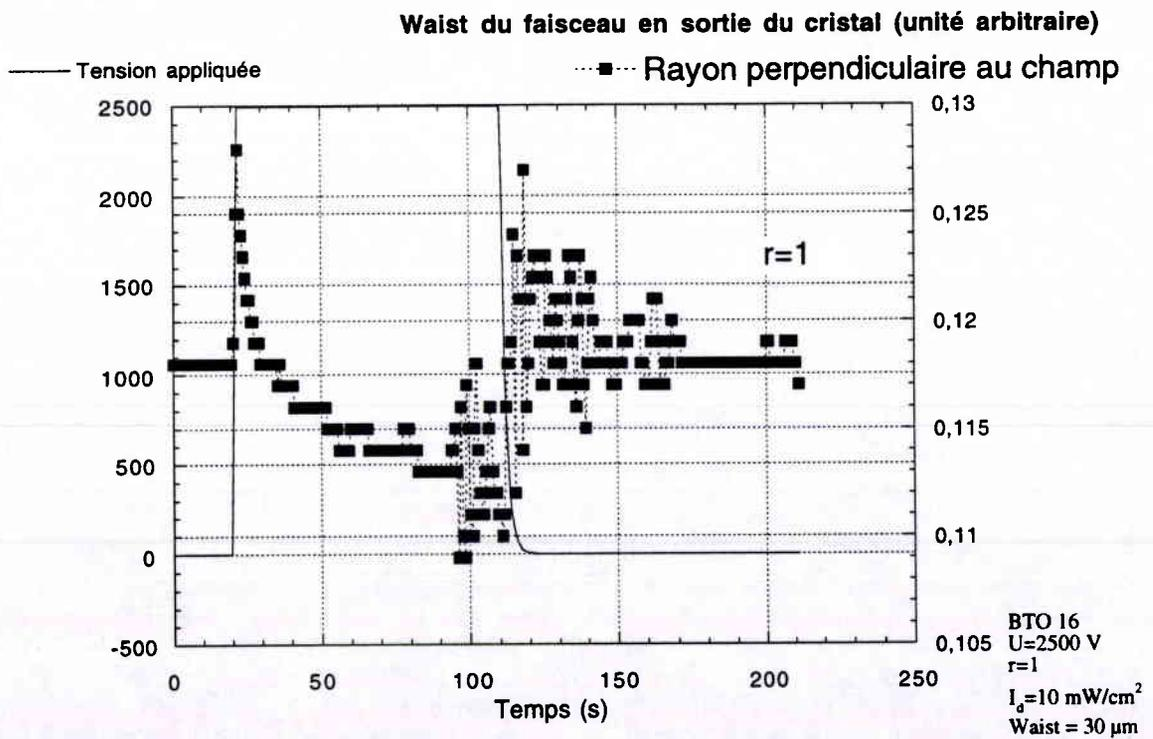
Figure 26 : mesures brutes pour BTO16, U=2500 V, I<sub>d</sub>=10mW/cm<sup>2</sup>, Waist 30 μm
