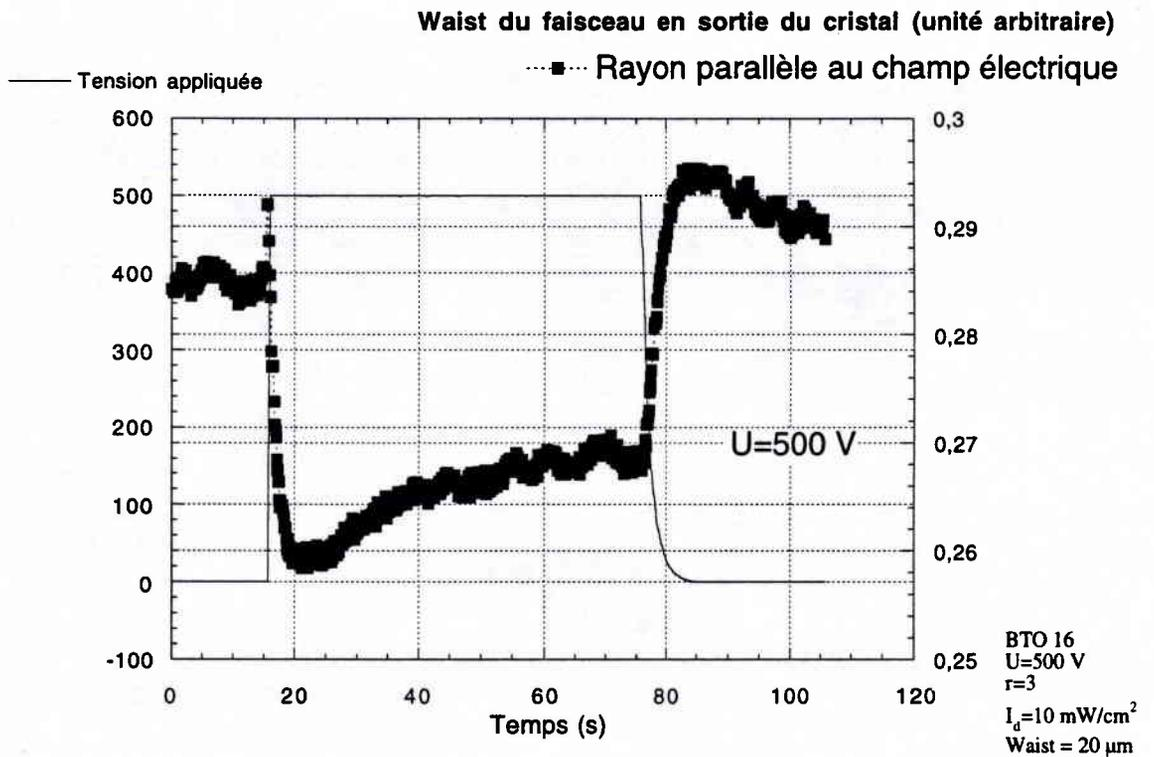
Figure 34 : Evolution temporelle du coefficient de diffraction parallèle au champ pour  $r=3$  et une tension appliquée de (a)100, (b)500, (c)1000 et (d)2500 V.
