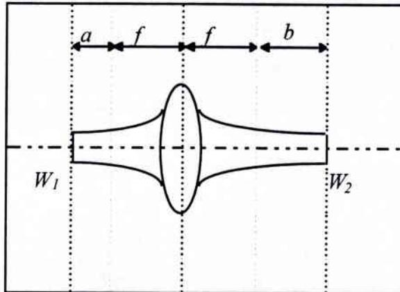
Pour une lentille mince de focale  $f$ , les formules de conjugaison des faisceaux gaussiens donnent :  $ab = f^2$  et  $a/b = (W_2/W_1)^2$ . Elles permettent d'obtenir les distances  $p_1$  et  $p_2$  en fonction de  $W_1$  et  $W_2$  :
