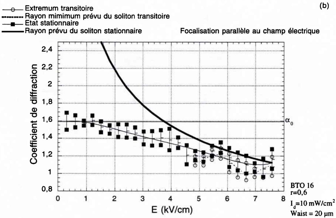
Figure 50: comparaison des résultats expérimentaux obtenus avec un waist d'entrée de  $20 \mu\text{m}$ , pour différents  $r$ , avec le rayon des solitons stationnaire et transitoire prévus.
