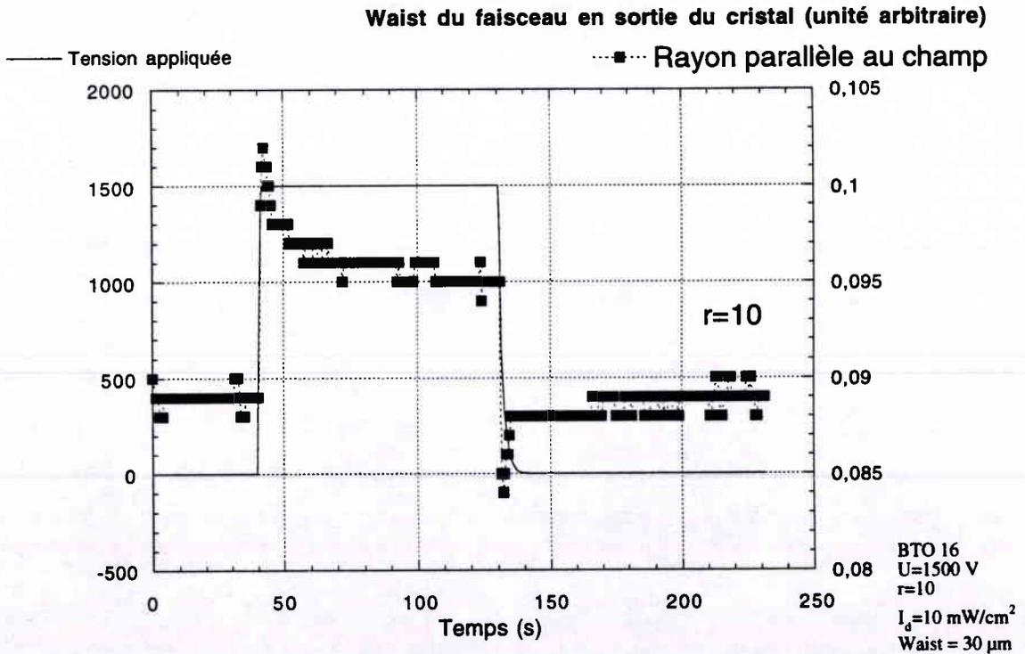
Figure 27 : mesures brutes pour BTO16,  $U=1500 \text{ V}$ ,  $I_d=10 \text{ mW/cm}^2$ , Waist 30  $\mu\text{m}$
