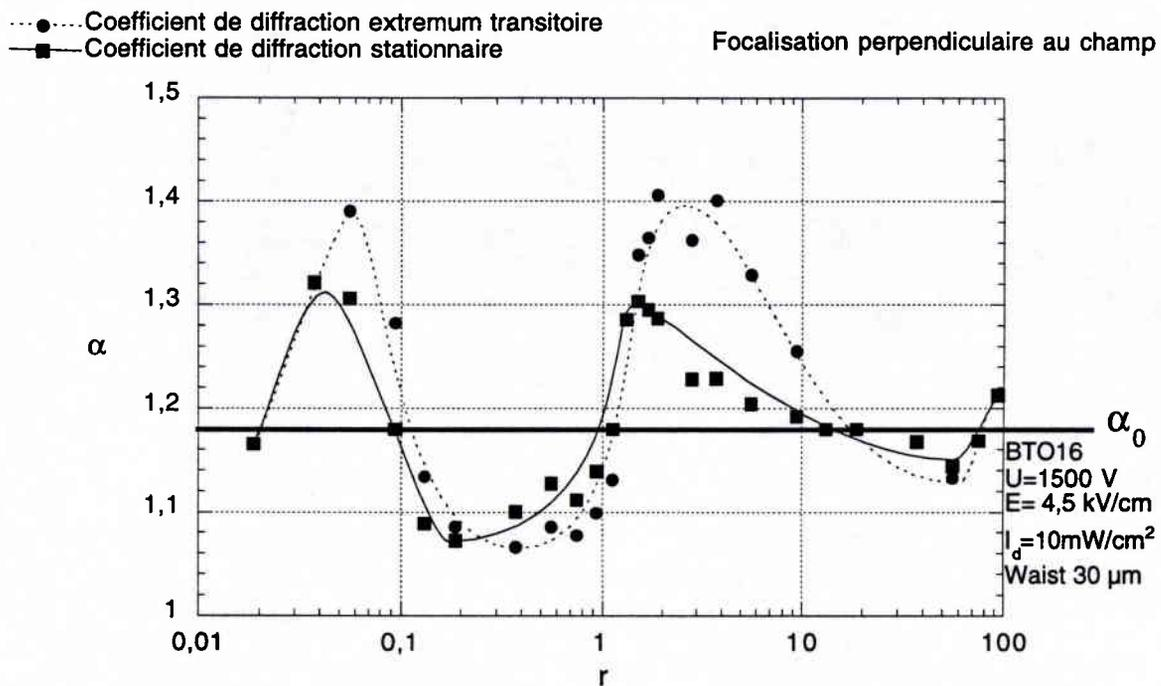
Figure 32 :coefficient de diffraction pour BTO16, 1500V,  $I_d=10 \text{ mW/cm}^2$
