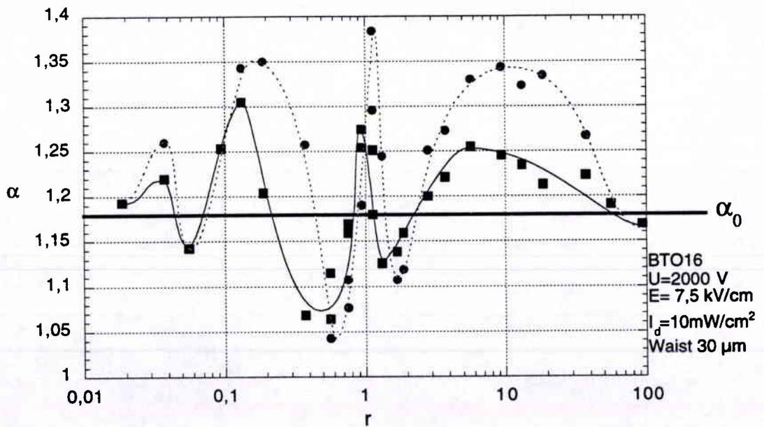
Figure 31 : coefficient de diffraction pour BTO16, 2000V,  $I_d=10 \text{ mW/cm}^2$
