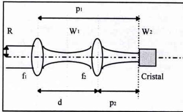
Le zoom représenté ci-dessus permet, en déplaçant les deux lentilles, de régler la taille du waist à l'entrée du cristal, en préservant la planéité du front d'onde. Les formules de conjugaison des faisceaux gaussiens permettent de déterminer les distances  $p_1$  et  $p_2$  en fonction de la taille du waist désiré.
