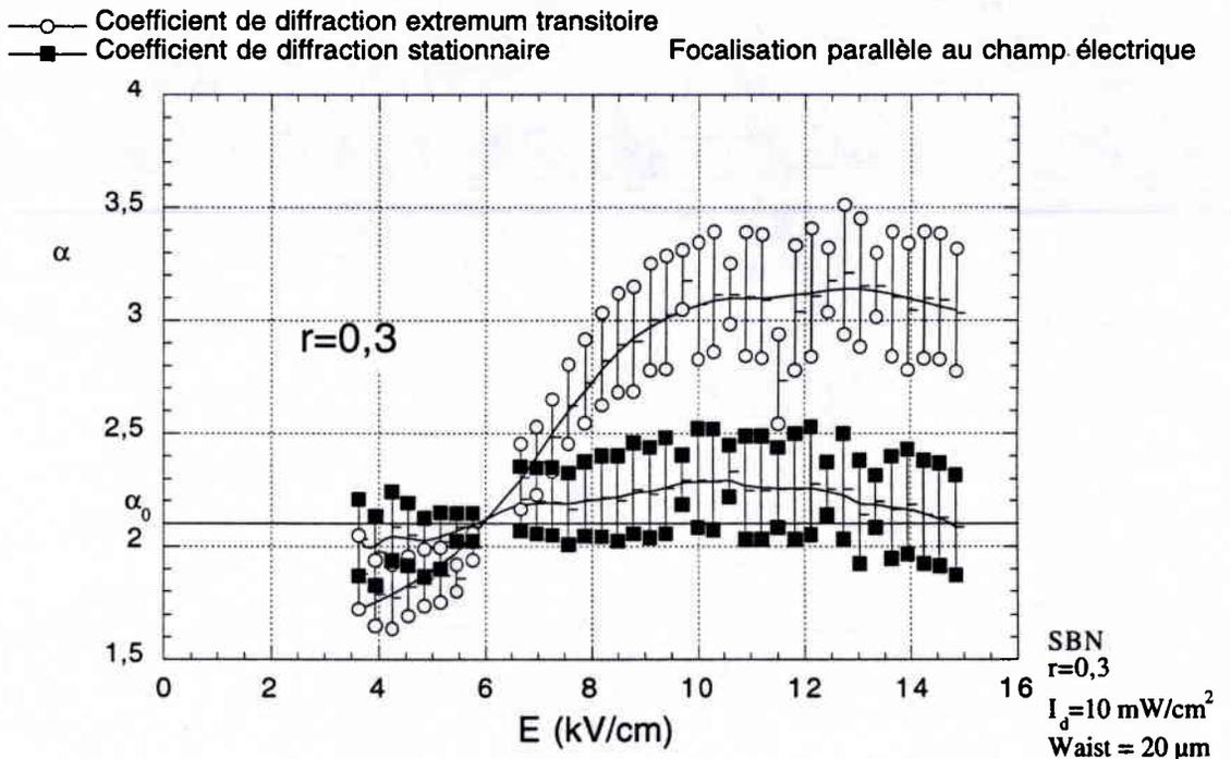
Figure 44 : coefficient de diffraction parallèle au champ électrique pour SBN, (a)  $r=0.3$ , (b)  $r=3$ , (c)  $r=30$ ,  $I_d=10 \text{ mW/cm}^2$ , Waist  $20 \mu\text{m}$
