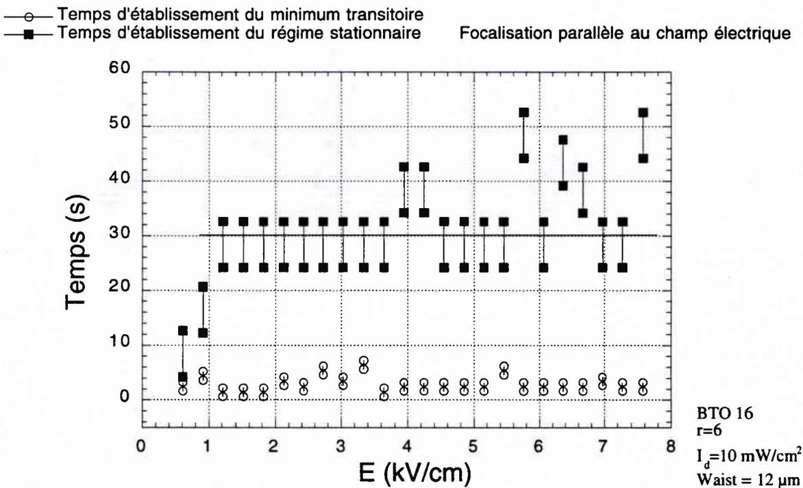
Figure 51: Temps d'établissement du minimum transitoire et de l'état stationnaire obtenus avec un waist d'entrée de  $12 \mu\text{m}$ , pour différents  $r$ .
