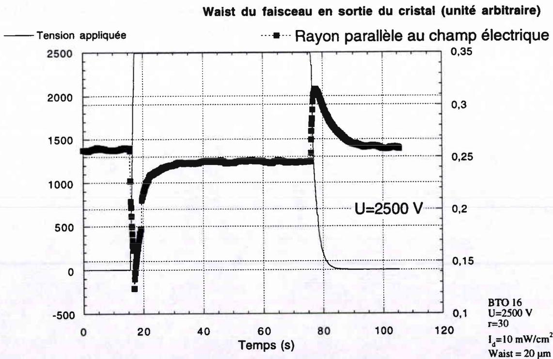
Figure 35 (suite) : Evolution temporelle du coefficient de diffraction parallèle au champ pour  $r=30$  et une tension appliquée de (a) 100, (b) 500, (c) 1000 et (d) 2500 V.
