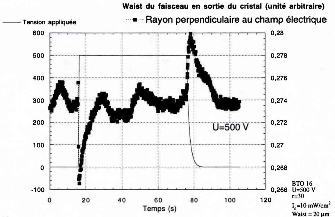
Figure 38 : Evolution temporelle du coefficient de diffraction perpendiculaire au champ pour  $r=30$  et une tension appliquée de (a) 100, (b) 500, (c) 1000 et (d) 2500 V.
