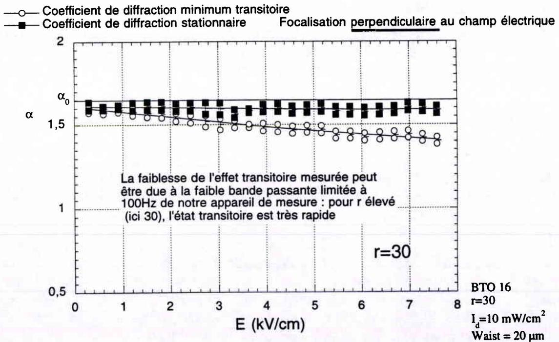
Figure 41 : coefficient de diffraction pour BTO16,  $r=30$ ,  $I_d=10 \text{ mW/cm}^2$ , Waist 20  $\mu\text{m}$
