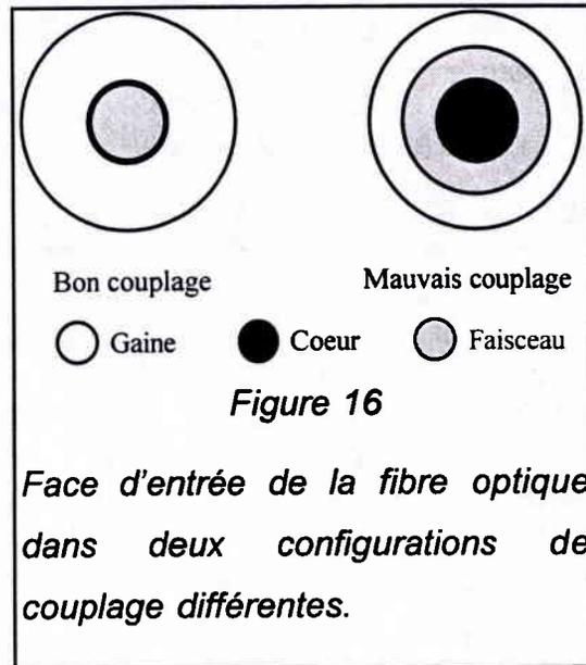
qualité du faisceau. Cette technique permet d'obtenir un faisceau gaussien divergent de très bonne qualité. Une simple lentille dont le point focal se situe en sortie de fibre permet l'obtention d'un faisceau gaussien rectiligne de très bonne qualité.
