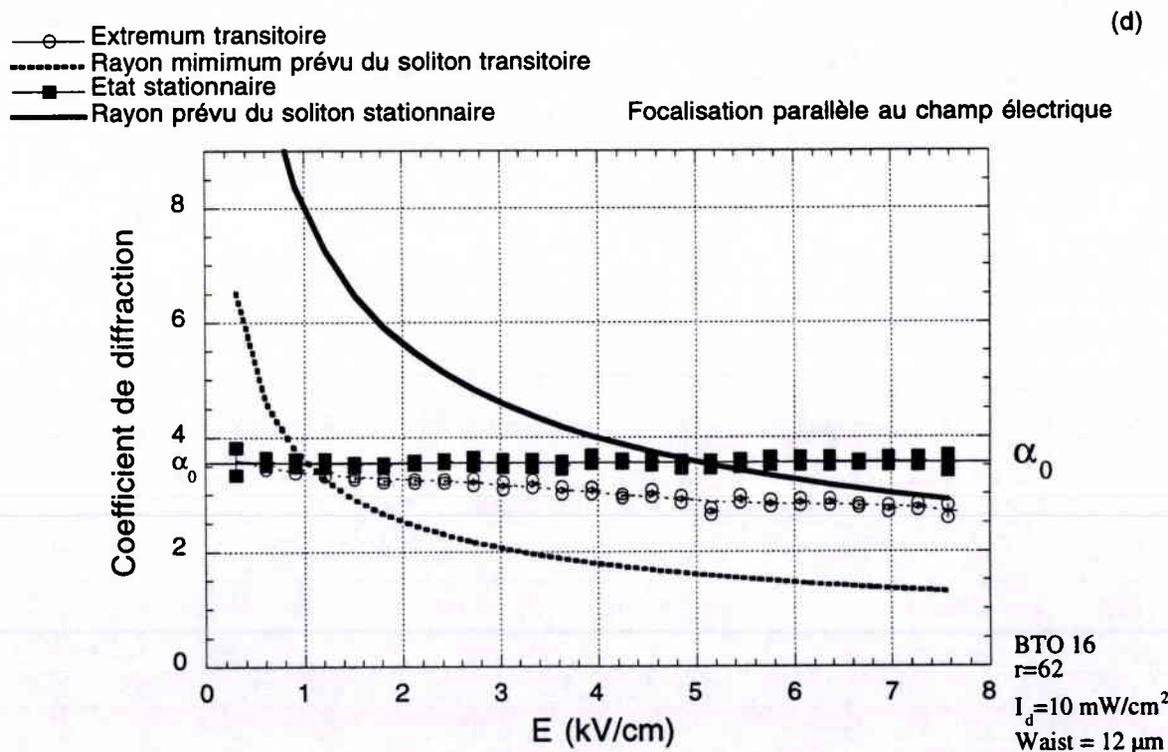
Figure 49 (suite): comparaison des résultats expérimentaux obtenus avec un waist d'entrée de  $12 \mu\text{m}$ , pour différents  $r$ , avec le rayon des solitons stationnaire et transitoire prévus.
