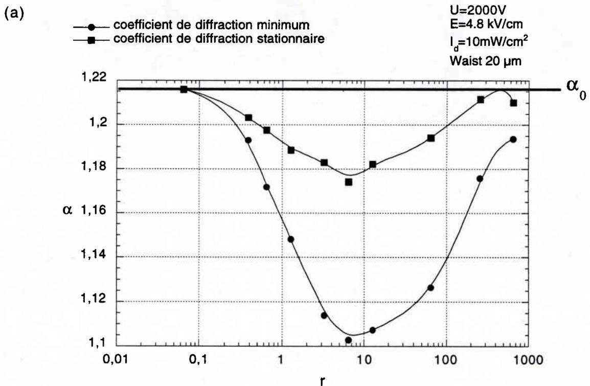
Figure 24 :coefficient de diffraction pour BTO18, 2000V,  $I_d=10 \text{ mW/cm}^2$  et pour des waists d'entrée de (a) 20 $\mu\text{m}$ , (b) 30 $\mu\text{m}$  et (c) 50 $\mu\text{m}$
