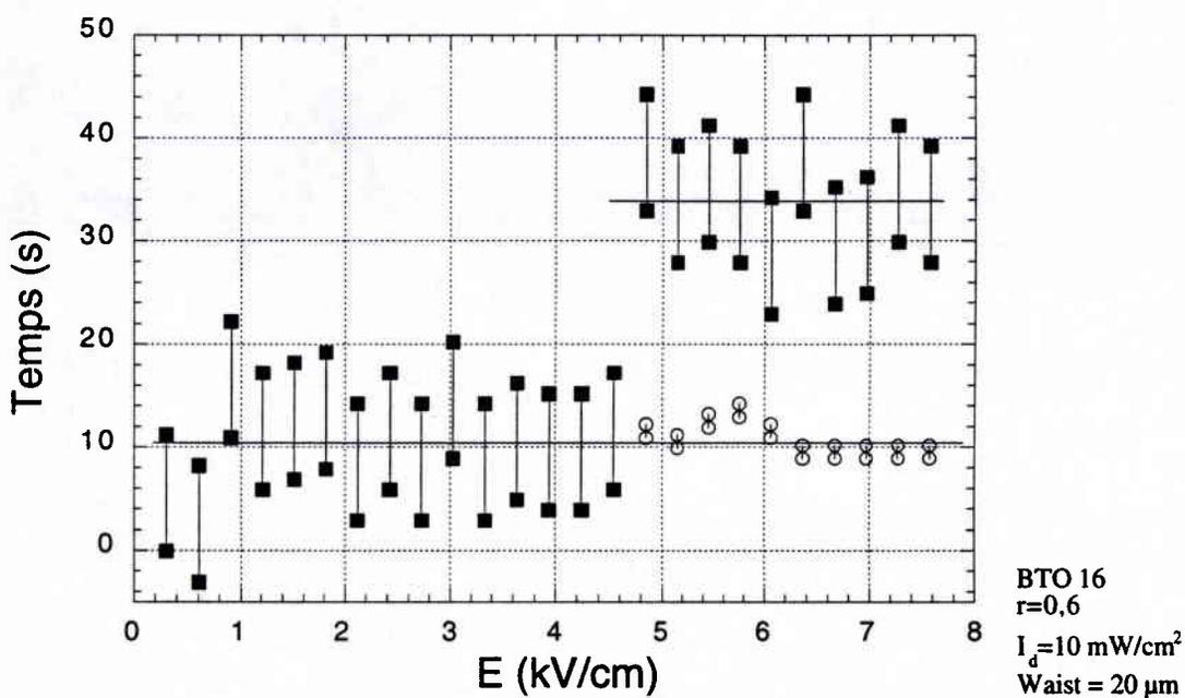
Figure 52: Temps d'établissement du minimum transitoire et de l'état stationnaire obtenus avec un waist d'entrée de  $20 \mu\text{m}$ , pour différents  $r$ .
