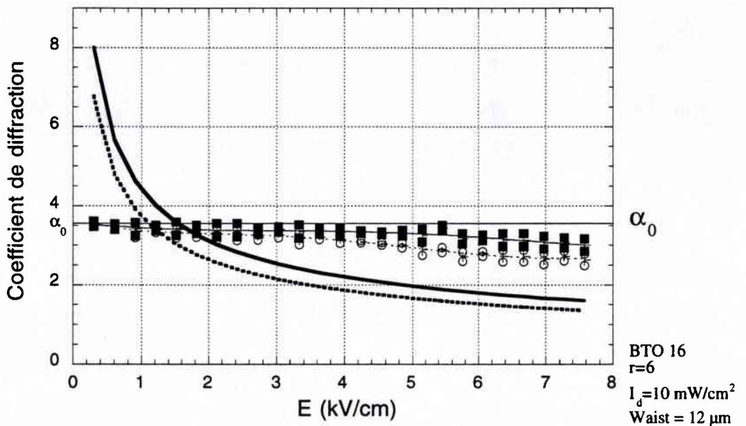
Figure 49: comparaison des résultats expérimentaux obtenus avec un waist d'entrée de  $12 \mu\text{m}$ , pour différents  $r$ , avec le rayon des solitons stationnaire et transitoire prévus.
