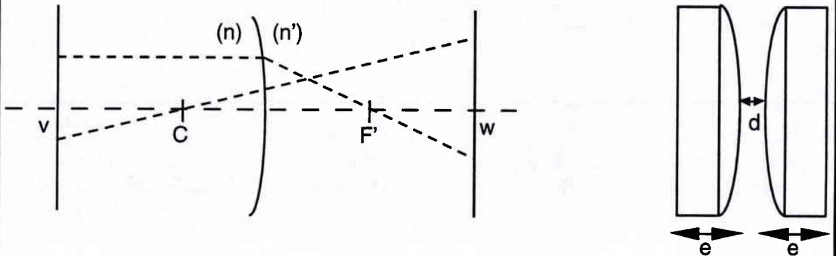
Dans ce cas, l'analyse de la propagation des deux rayons indiqués sur la figure ci-dessus permet de trouver la matrice  $M$  du système optique situé entre les deux plans d'abscisses  $v$  et  $w$ , pour une propagation de  $v$  vers  $w$ , pour un dioptre sphérique de rayon  $L$ .
