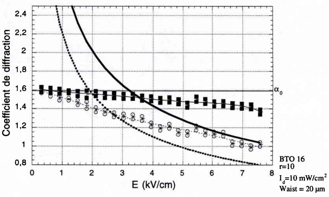
Figure 50 (suite): comparaison des résultats expérimentaux obtenus avec un waist d'entrée de 20  $\mu\text{m}$ , pour différents r, avec le rayon des solitons stationnaire et transitoire prévus.
