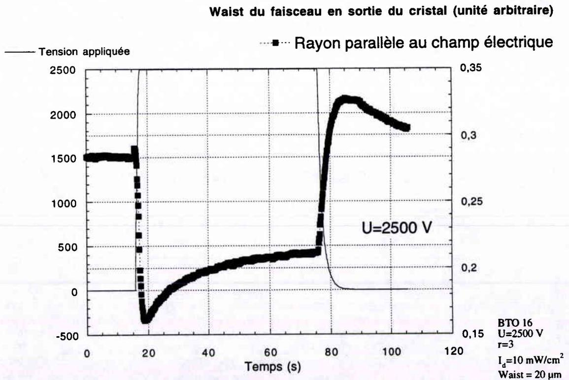
Figure 34 (suite) : Evolution temporelle du coefficient de diffraction parallèle au champ pour  $r=3$  et une tension appliquée de (a)100, (b)500, (c)1000 et (d)2500 V.
