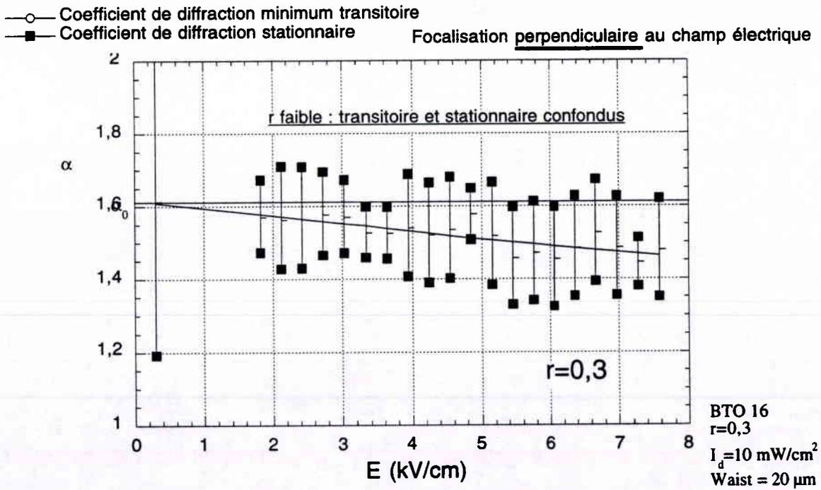
Figure 39 : coefficient de diffraction pour BTO16,  $r=0,3$ ,  $I_d=10 \text{ mW/cm}^2$ , Waist  $20 \mu\text{m}$
