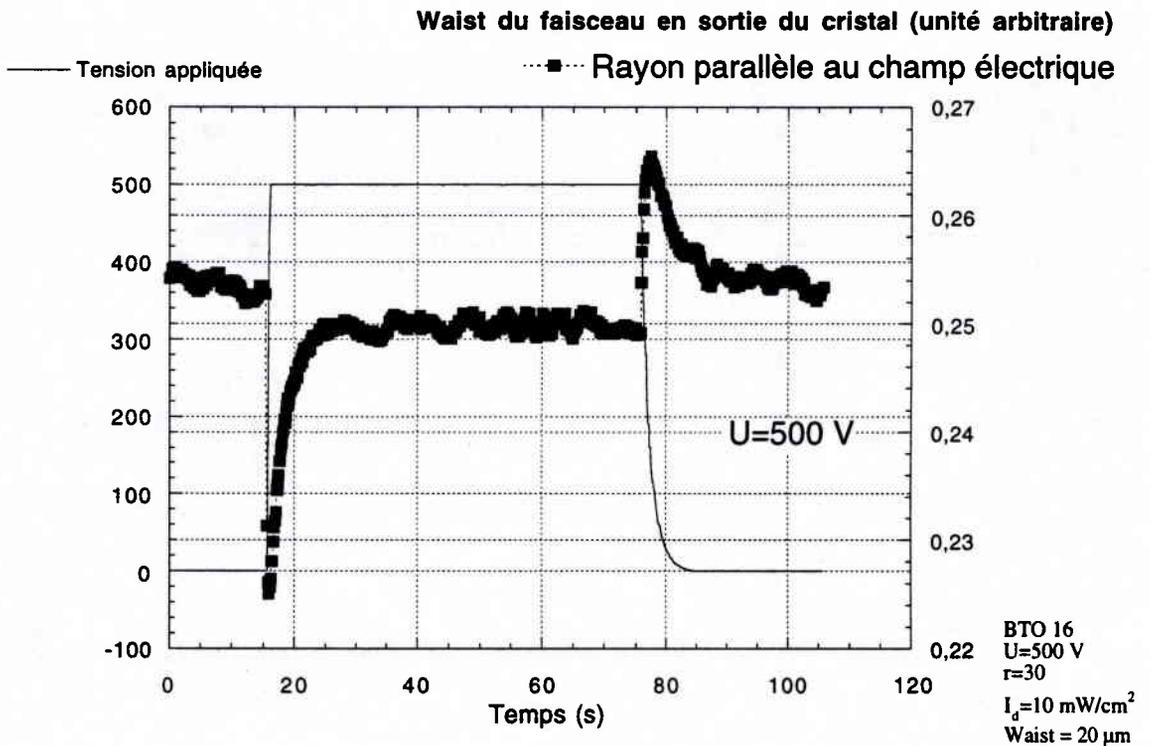
*Figure 35 : Evolution temporelle du coefficient de diffraction parallèle au champ pour  $r=30$  et une tension appliquée de (a) 100, (b) 500, (c) 1000 et (d) 2500 V.*
