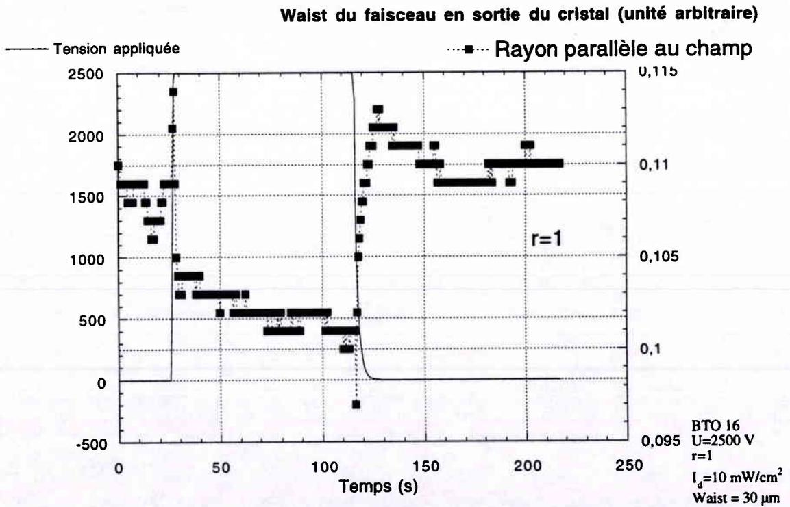
Figure 25 : mesures brutes pour BTO16,  $U=2500\text{ V}$ ,  $I_d=10\text{ mW/cm}^2$ , Waist  $30\ \mu\text{m}$
