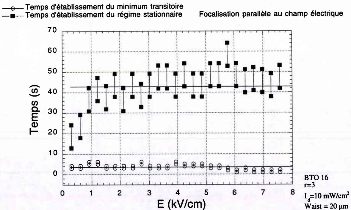
Figure 52 (suite) : Temps d'établissement du minimum transitoire et de l'état stationnaire obtenus avec un waist d'entrée de 20  $\mu\text{m}$ , pour différents r.
