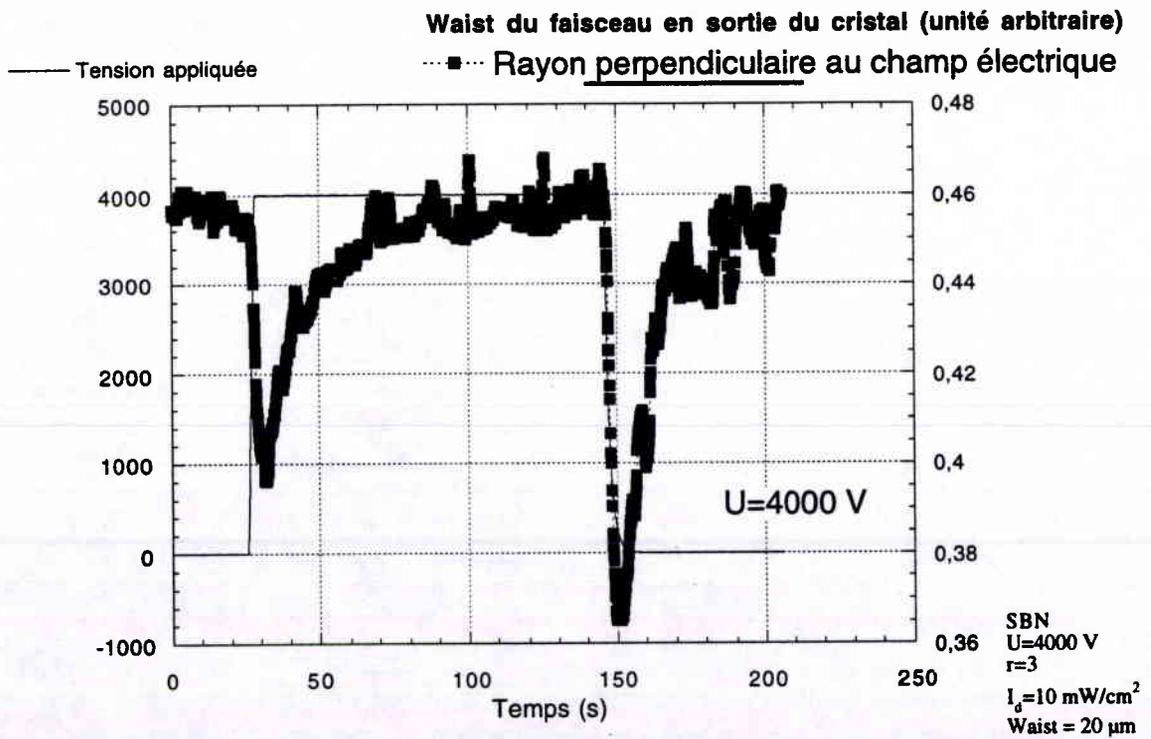
**Figure 43 : Evolution temporelle du coefficient de diffraction perpendiculaire au champ pour  $r=3$  et une tension appliquée de (a)1000 V, (b)4000 V**
