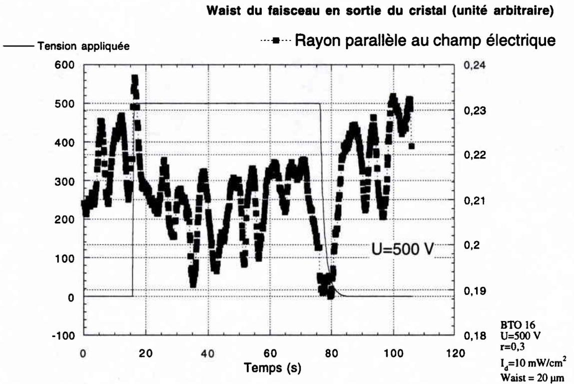
Figure 33 : Evolution temporelle du coefficient de diffraction parallèle au champ pour  $r=0,3$  et une tension appliquée de (a)100, (b)500, (c)1000 et (d)2500 V.
