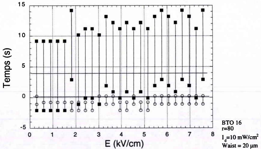
Figure 52 (suite) : Temps d'établissement du minimum transitoire et de l'état stationnaire obtenus avec un waist d'entrée de 20  $\mu\text{m}$ , pour différents r.
