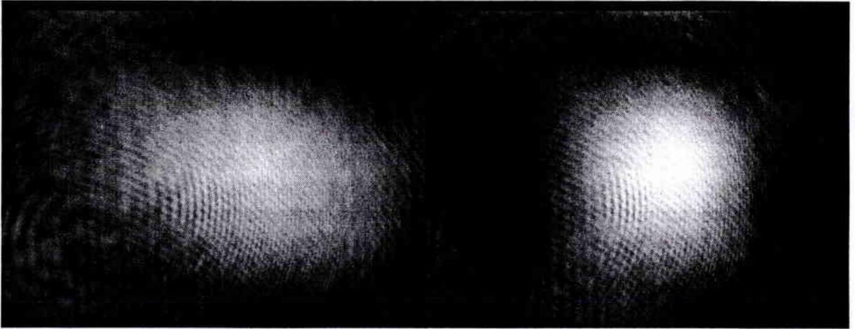
*Figure 46 : obtention d'un soliton spatial dans  $\text{BaTiO}_3$  pour  $r=10$  à la tension prévue de 400 V (soit 1,2 kV/cm). La largeur de l'image est de 150  $\mu\text{m}$ .*
