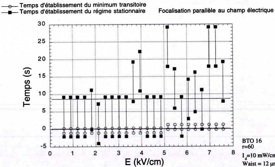
Figure 51 (suite) : Temps d'établissement du minimum transitoire et de l'état stationnaire obtenus avec un waist d'entrée de  $12 \mu\text{m}$ , pour différents  $r$ .
