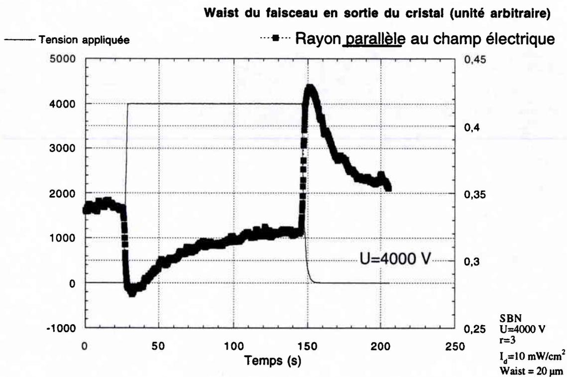
*Figure 42 : Evolution temporelle du coefficient de diffraction parallèle au champ pour  $r=3$  et une tension appliquée de (a) 1000 V, (b) 4000 V*
