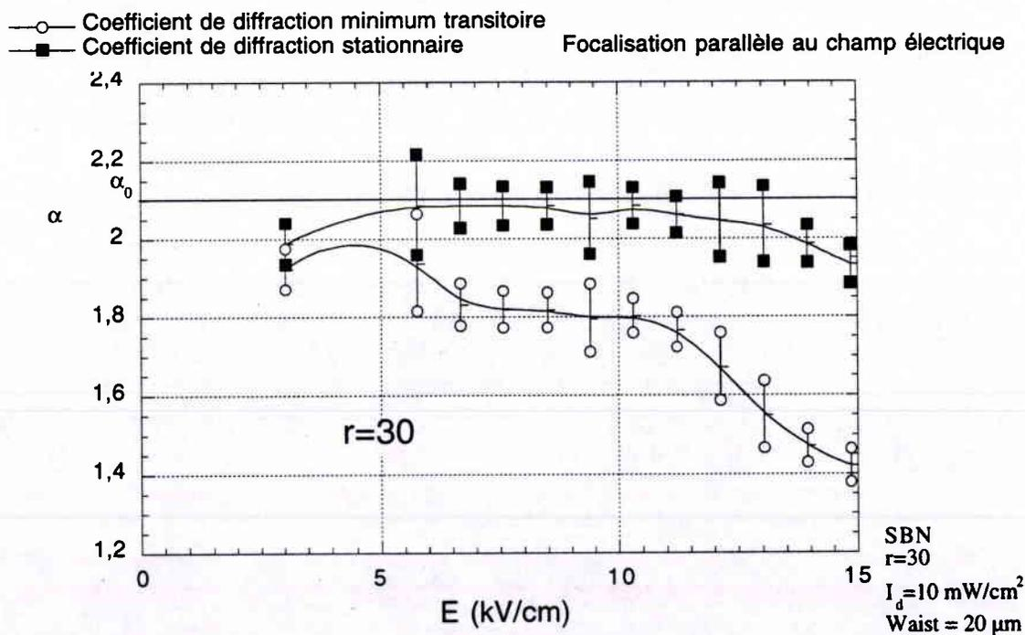
Figure 44 (suite) : coefficient de diffraction parallèle au champ électrique pour SBN, (a)  $r=0.3$ , (b)  $r=3$ , (c)  $r=30$ ,  $I_d=10 \text{ mW/cm}^2$ , Waist  $20 \mu\text{m}$
