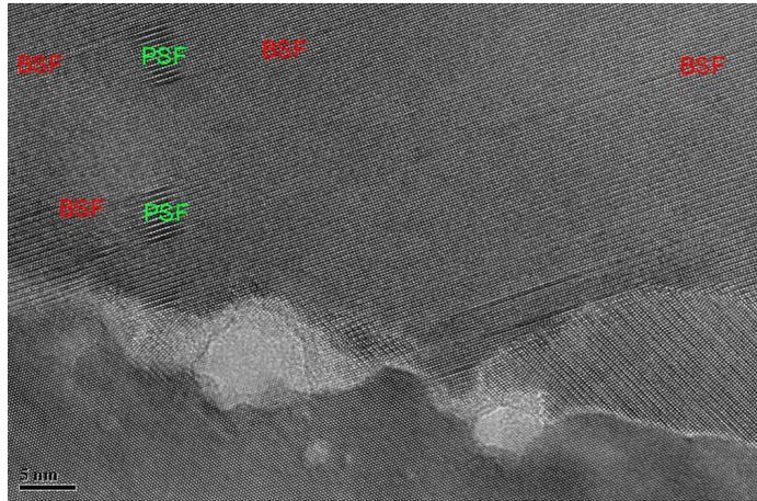
En conclusion on peut dire que les microstructures des films semi-polaires de III-N sur saphir M sont très semblables à celles des films non-polaires sur saphir R avec de fortes densités de BSF et des défauts liés (PD et PSF). Dans le cas de l'orientation  $(10\bar{1}3)$ , on a en plus des macles dont l'existence est directement une conséquence des relations d'épitaxie. Ces films contiennent également des inversions de domaine.
