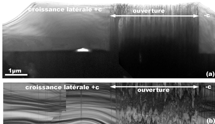
Figure IV-7 : images en-section (a) et en axe de zone  $[11\bar{2}0]$  (b) d'un film semi-polaire ELO.
