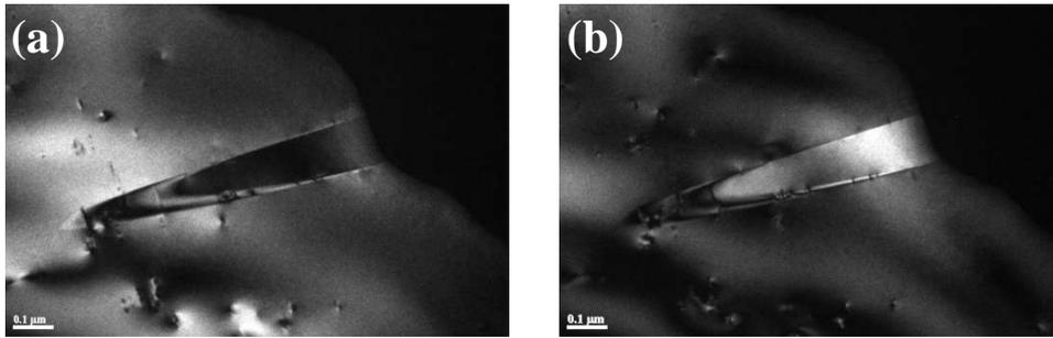
Figure III-3 : image en champ sombre (0002) (a) et (000 $\bar{2}$ ) (b) d'un domaine d'inversion dans la couche B.
