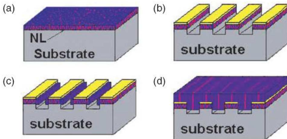
Figure IV-8 : représentation schématique de la pendeo-épitaxie.
