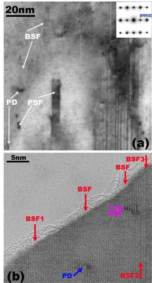
Le tableau II-2 décrit les différentes fautes d'empilement basales (avec les PD liées) qui existent dans la structure wurzite<sup>47</sup> et les règles d'extinction qui permettent de les caractériser en imagerie en champ sombre. On peut également caractériser les BSF en imagerie haute résolution. La figure II-13 est ainsi une image haute résolution de la faute appelée BSF1 de la
