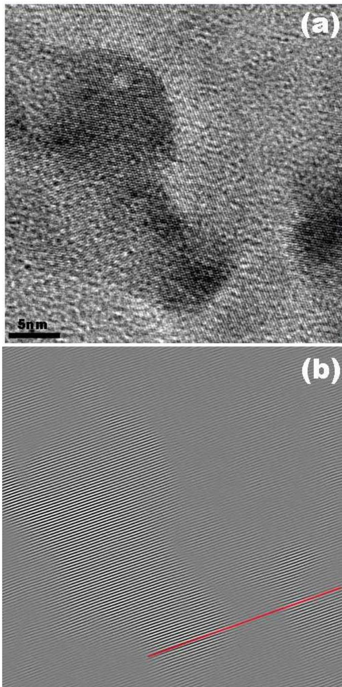
Figure II-19 : (a) image haute résolution en vue plane d'un dépôt de 1 minute de ZnO sur saphir plan R ; (b) transformée de Fourier inverse en sélectionnant uniquement la tache  $(1\bar{1}00)$  .
