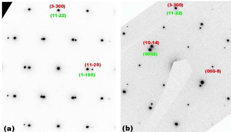
Figure III-2 : SAED en section transverse du saphir et de la couche C selon les axes de zone perpendiculaires  $[0001]$  (a) et  $[11\bar{2}0]$  (b) du saphir. Les indexations du saphir sont en rouge et celles du GaN en vert.
