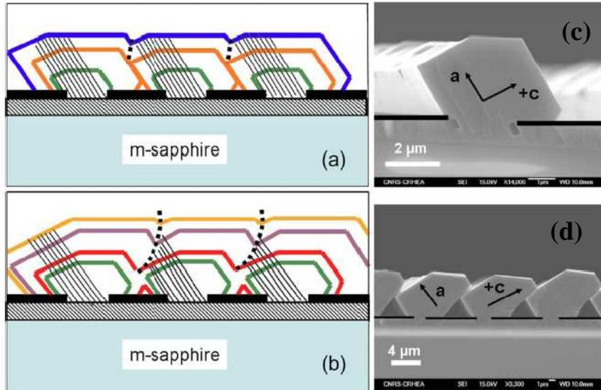
Figure IV-9: représentation schématique des différentes étapes de la croissance S-ELO (a) et AS-ELO (b) ; images MEB de 2 étapes de la croissance AS-ELO (c) et (d).
