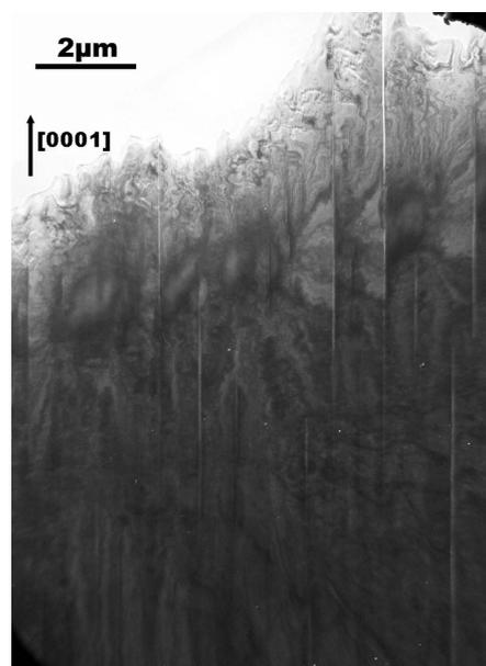
Figure IV-2 : image en vue plane à faible grandissement d'une couche de GaN déposée sur ZnO plan A.
