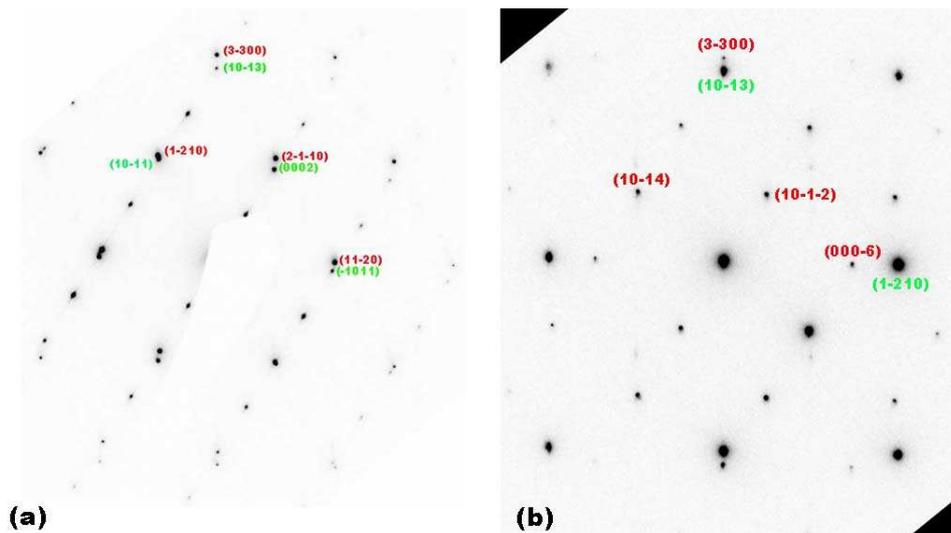
Figure III-1 : SAED en section transverse du saphir et de la couche B selon les axes de zone perpendiculaires [0001] (a) et[11 $\bar{2}$ 0] (b) du saphir. Les indexations du saphir sont en rouge et celles du GaN en vert.
