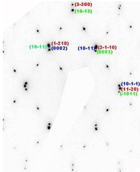
Figure III-5 : SAED incluant le substrat de saphir (axe de zone  $[0001]$ ) et 2 orientations du GaN en position de macle (axe de zone  $[1\bar{2}10]$ ). Les taches du saphir sont indexées en rouge, celles des 2 macles du GaN en vert et en bleu.
