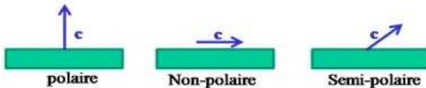
Figure I-6 : définition des termes utilisés pour décrire les orientations des couches.
