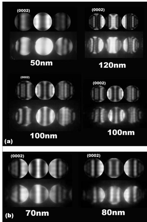
Figure II-3 : diffractions électroniques en faisceau convergent simulées et expérimentales (haut et bas respectivement) en axe de zone  $[1\bar{1}00]$  pour le substrat 6H-SiC (a) et la couche AlN (b). Chaque diffraction correspond à une position différente. Les épaisseurs des objets MET sont indiquées.
