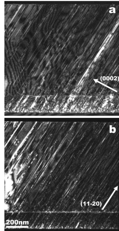
Pour permettre une caractérisation plus précise de ces défauts, des observations selon l'axe de zone  $[11\bar{2}0]$  incliné de  $32^\circ$  par rapport à l'orientation en vue plane ont été faites.
