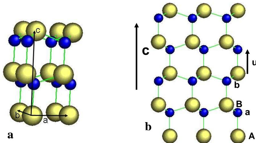
Figure I-1 : représentation de la structure wurtzite ; en perspective (a) ; en projection selon l'axe de zone  $\langle 11\bar{2}0 \rangle$  (b). Les cations sont représentés en jaune, les anions en bleu.
