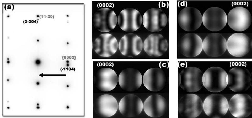
Figure II-9 : SAED d'une couche de ZnO sur saphir plan R en axe de zone  $[11\bar{2}0]_{\text{sap}}$  ( $[1\bar{1}00]_{\text{ZnO}}$ ) (a). Les taches du saphir sont indexées en noire, celles du ZnO en gris. Le sens de référence dans le saphir est représenté par la flèche noire. CBED simulées (haut) et expérimentales (bas) pour le ZnO (b, c) et le GaN (d, e). Les épaisseurs des objets sont 83 nm (b), 40 nm (c), 32 nm (d) et 50 nm (e).
