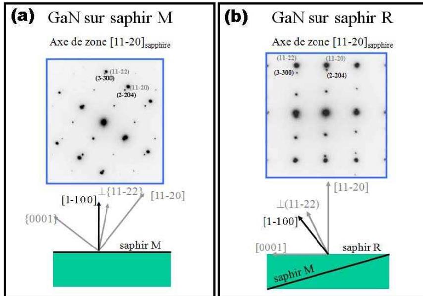
Figure III-11 : SAED en section transverse en axe de zone  $[11\bar{2}0]_{\text{sap}}$  et représentation schématique des orientations pour la croissance de III-N sur saphir M (a) et R (b). Les taches du saphir sont indexées en noir, celles du III-N en gris.
