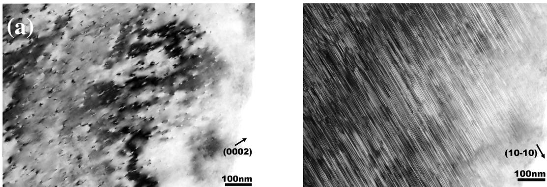
Figure II-11 : Images en vue-plane d'un film de GaN sur SiC 6H ; (a) champ clair (0002), les DPB sont hors-contraste, on n'observe que les PD. (d) champ clair (10 $\bar{1}$ 0), les BPD et les PD sont en contraste.
