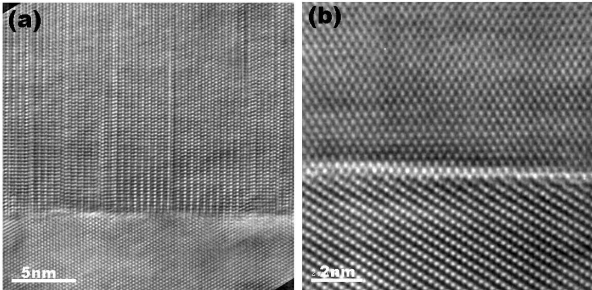
Figure III-7 : images METHR de l'interface GaN/saphir plan M pour l'échantillon A ; (a) axe de zone  $[0001]_{\text{sap}}$ ; (b) axe de zone  $[11\bar{2}0]_{\text{sap}}$ .
