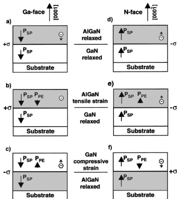
Figure I-3 : polarisations spontanées et piézoélectriques pour des hétérostructures contraintes  $\text{AlGaIn}/\text{GaInN}$  ou  $\text{GaInN}/\text{AlGaIn}$  épitaxiées selon des orientations  $[0001]$  et  $[000\bar{1}]$ , d'après Ambacher et al<sup>3</sup>.
