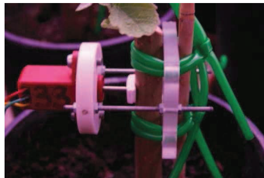
Figure 5.2 Dendromètre mesurant en permanence l'accroissement du diamètre de la tige de la plante.
