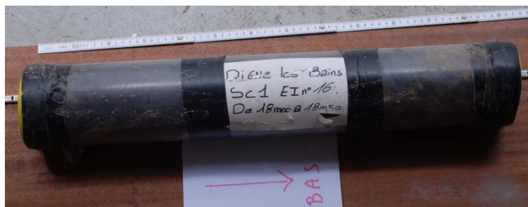
FIG. 4.8 – Exemple de carotte dans son tube de stockage.
