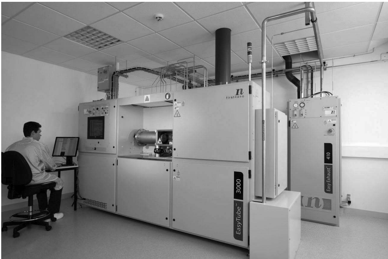
FIGURE 2.3 – Réacteur CVD EasyWire, CEA-INAC/SPMM. Responsable Pascal Gentile.
