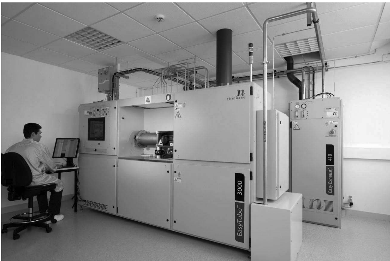
FIGURE 2.3 – Réacteur CVD EasyWire, CEA-INAC/SPMM. Responsable Pascal Gentile.
