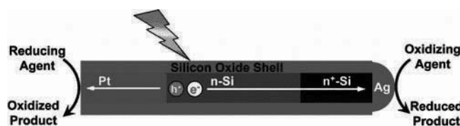
FIGURE 1.9 – Utilisation des nanofils de silicium pour la réalisation de photocatalyseurs à spectre large. Extrait de Qu et al.[38].
