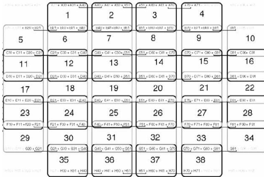
FIG. 2.12: Schéma de sectorisation d'une caméra de H.E.S.S.
