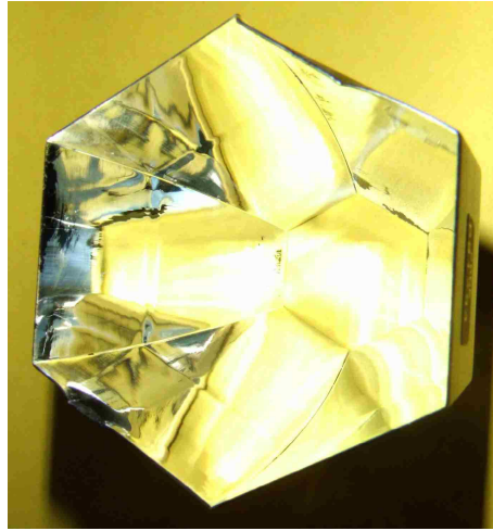
FIG. 2.9: Photographie d'un des cônes de Winston surmontant les photomultiplicateurs de H.E.S.S.
