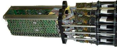
FIG. 2.7: Vue de profil d'un des tiroirs de H.E.S.S. contenant 16 PMs et l'électronique de lecture et de déclenchement local
