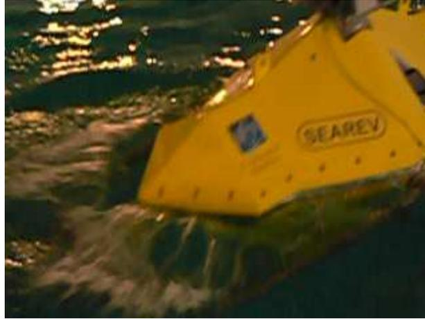
FIG. 9.8 – Cliché d'un impact de slamming observé lors des essais expérimentaux.
