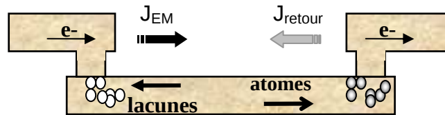
Figure II-7 : Effet du confinement dans une interconnexion
