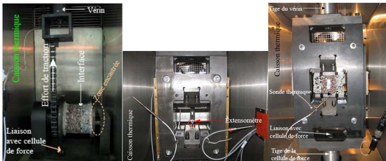
Figure IV.3-3. Eprouvette cylindrique ou prismatique mise en place sur le dispositif d'essai
