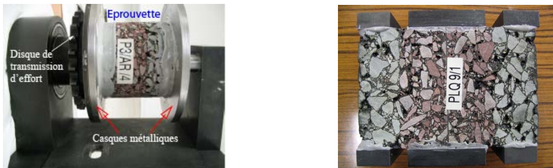
Figure IV.3-2. Eprouvette cylindrique ou prismatique collée sur casques métalliques
