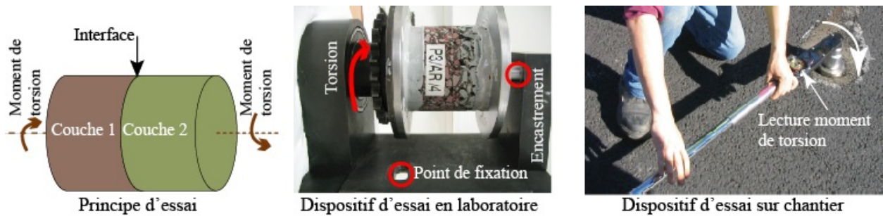
Figure II.1-7. Essai de torsion : principe d'essai et exemples de dispositifs d'essai (CRM Eurovia)
