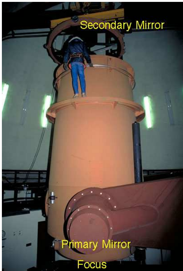
(a) Le télescope de 2.2 m de diamètre lors d'une maintenance. Crédit : Richard J. Wainscoat 2005
