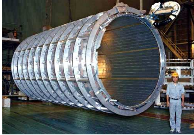
FIGURE 2.10 – Photographie de l'aimant solénoïdal avant son immersion dans le tonneau du cryostat d'argon liquide et sa descente dans la caverne.
