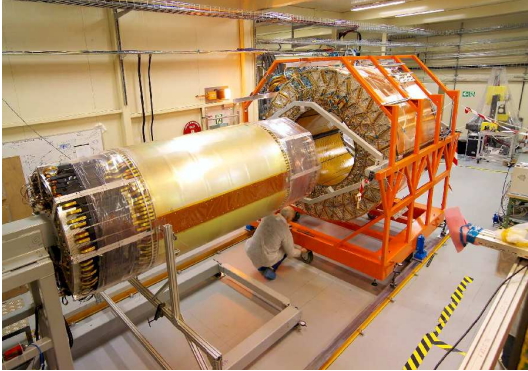
FIGURE 2.13 – Insertion du détecteur de traces à semi-conducteur tonneau dans le trajectographe à rayonnement de transition tonneau (gauche) et photo des tubes à dérives dans une roue des bouchons du TRT (droite)
