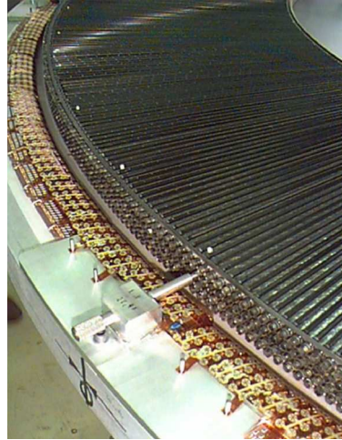
FIGURE 2.13 – Insertion du détecteur de traces à semi-conducteur tonneau dans le trajectographe à rayonnement de transition tonneau (gauche) et photo des tubes à dérives dans une roue des bouchons du TRT (droite)
