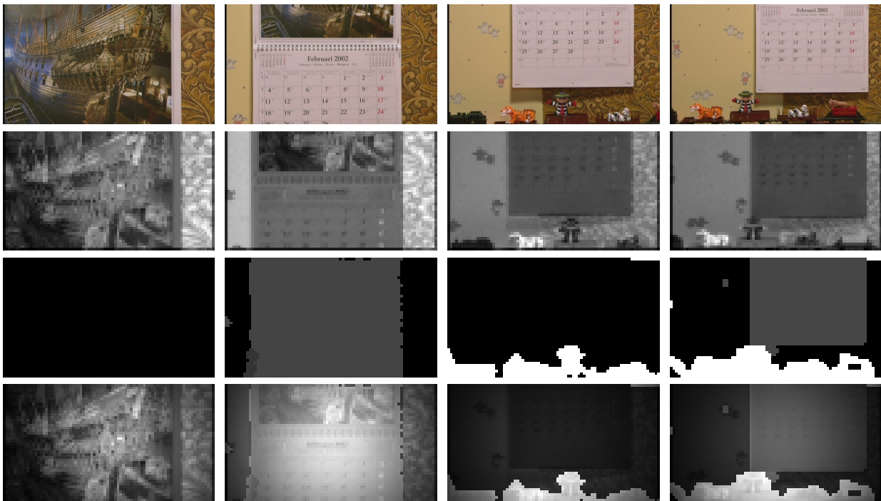
FIG. 3.33 – Cartes de saillance (normalisées pour l’affichage) pour la séquence New Mobile and Calendar (segments 1, 34, 49 et 54), avec de haut en bas : images originales (centres des segments), cartes de saillance spatiale, cartes de saillance temporelle et cartes de saillance spatio-temporelle.
