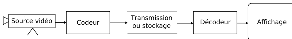
FIG. 1.1 – Schéma d'un codeur/décodeur.
