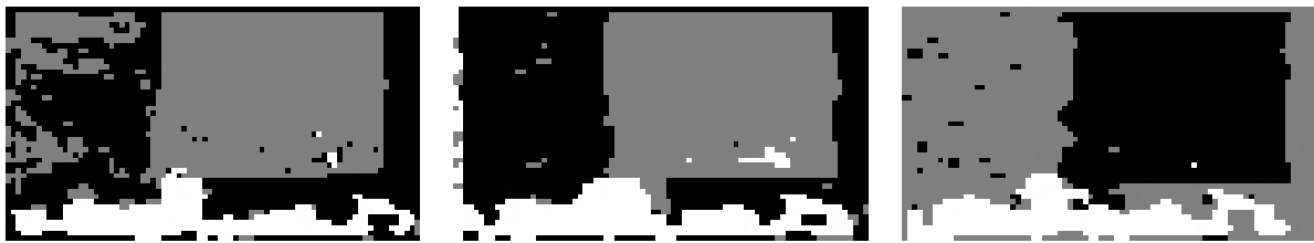
FIG. 3.22 – Cartes de segmentation basée mouvement obtenues pour trois segments temporels successifs (53, 54 et 55) de la séquence New Mobile and Calendar .
