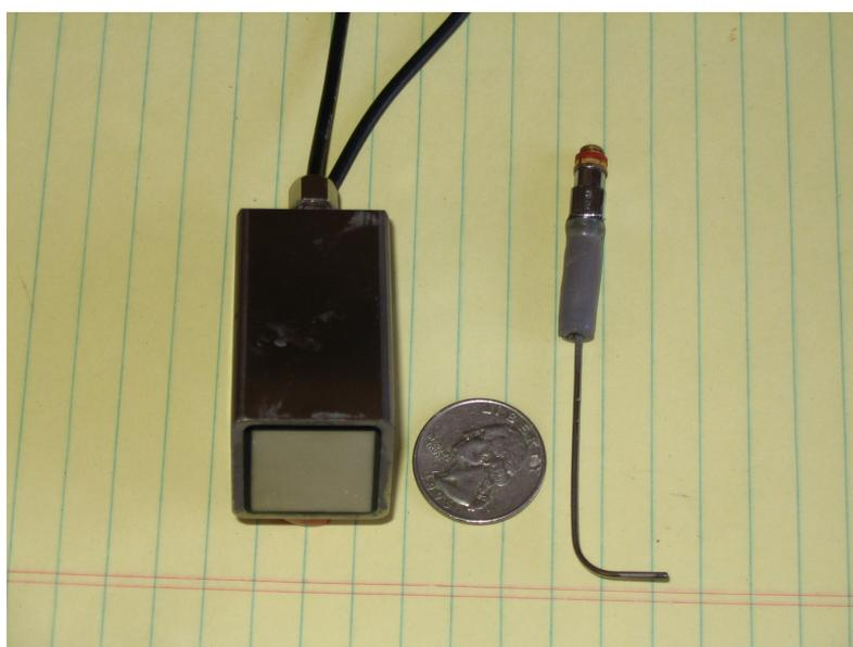
FIG. 2.15 : Barette d'émission (à gauche) et récepteur (à droite) utilisés pour la collecte des données petites échelles, fond acier (cuve MPL).
