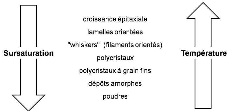
FIG. 2.11 – Effet de la température et de la sursaturation sur la morphologie des dépôts à partir d'une phase gazeuse [136]
