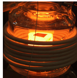
FIG. 4.21 – Photographie du suscepteur en graphite (jaune) et du substrat (brun) à haute température
