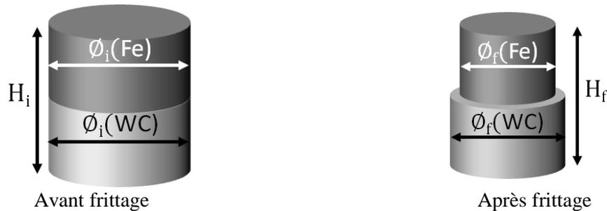
Figure 36 : Représentation schématique des échantillons avant et après frittage
