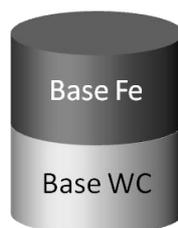
Figure 2 : Représentation schématique du bimatériau bicouche étudié
