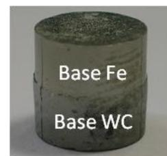
Figure 3 : Photographie d'un échantillon bimatériau fritté
