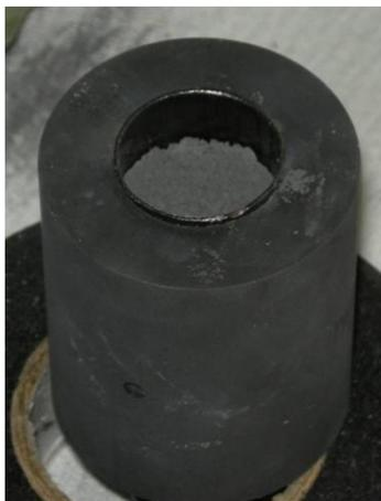
Figure 150 : Matrice en graphite contenant la poudre du matériau à fritter
