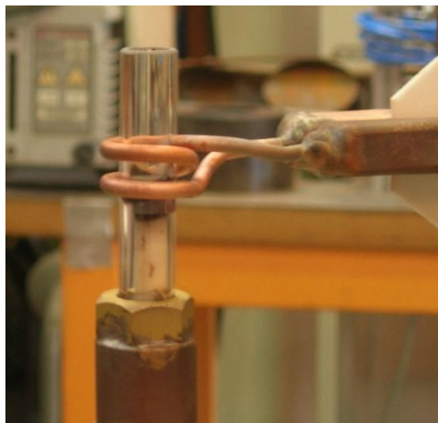
Figure 149 : Dispositif utilisé pour le frittage des échantillons de diamètre 8 mm
