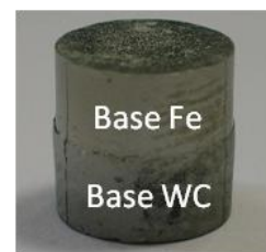
Figure 3 : Photographie d'un échantillon bimatériau fritté
