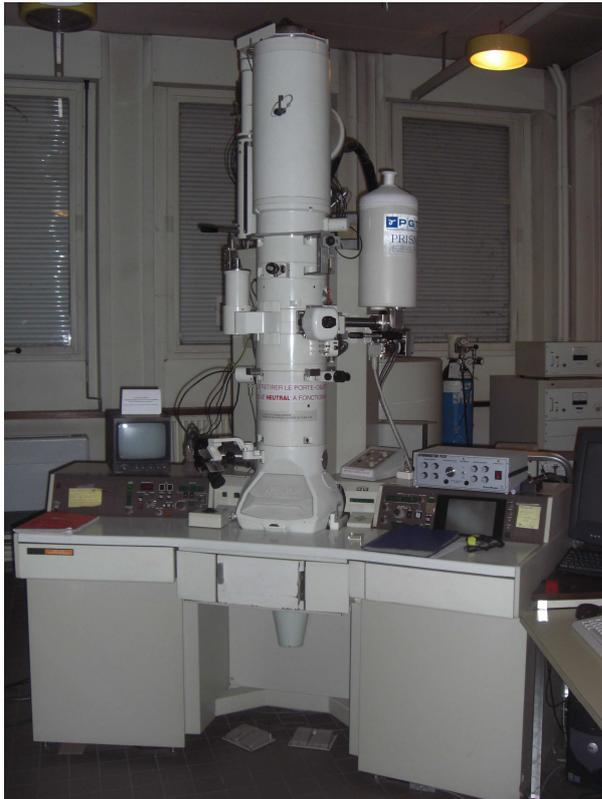
Figure II-8 : Le MET JEOL 3010 du laboratoire SIMaP.
