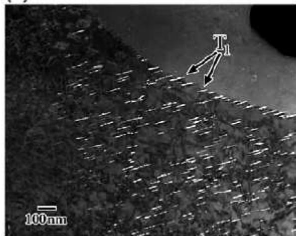
Figure I-22 : Champ sombre montrant de la précipitation de T1 aux joints de grains dans un Al-2.7Cu-1.8Li (wt%) après 24h à 150°C, (Csontos et Starke 2005).
