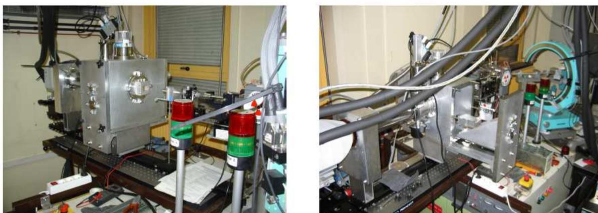
Figure II-20 : Photos de la ligne de diffusion du laboratoire. On observe l'enceinte au centre, fermée sur la première photo, ouverte sur la seconde.
