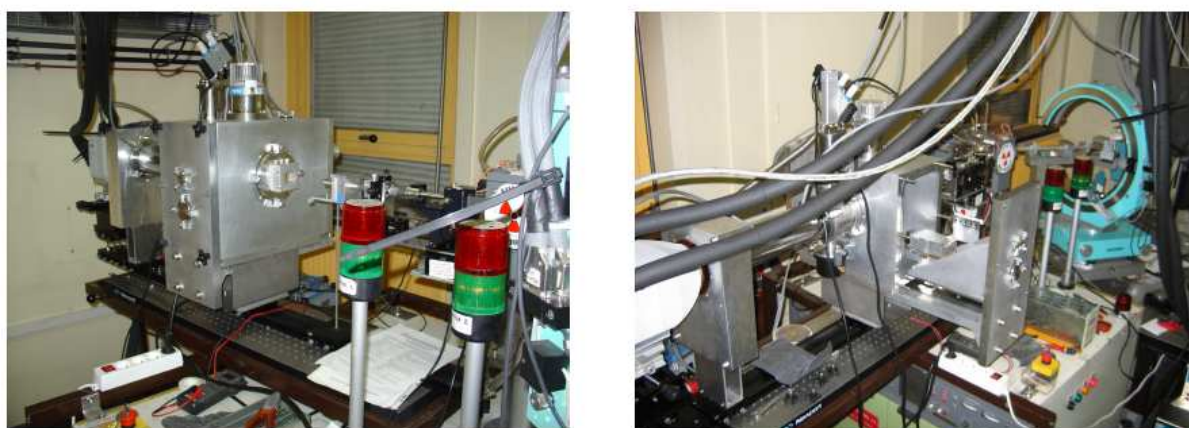
Figure II-20 : Photos de la ligne de diffusion du laboratoire. On observe l'enceinte au centre, fermée sur la première photo, ouverte sur la seconde.
