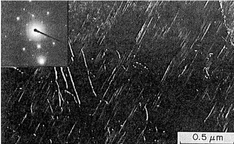
Figure I-12: Micrographie en champ sombre et figure de diffraction montrant la répartition des précipités de S (Khiredine, Rahouadj et al. 1989)
