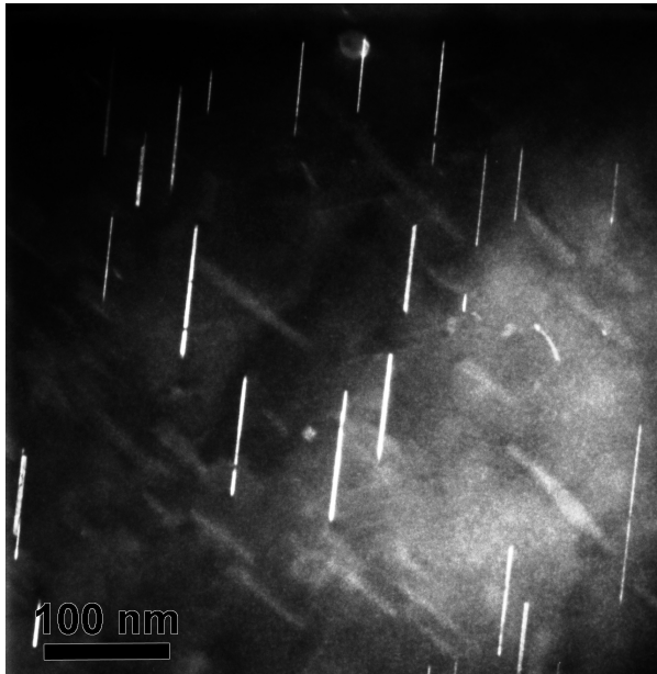
Figure III-26 : Champ sombre en axe de zone \{110\}_{Al} du AA2198 revenu 500 heures à 155°C. On observe bien les différences d'épaisseur entre les précipités
