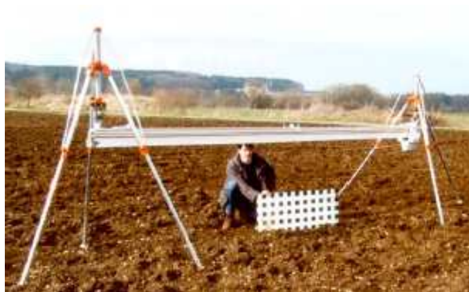
FIG. 1.14 – Deux méthodes de mesure de rugosité : le tableau gradué et le profilomètre laser [Davidson(2000)].
