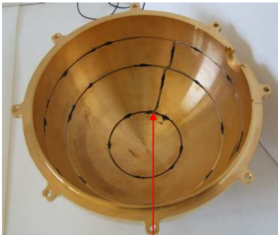
Fil chauffant avec points de colles
