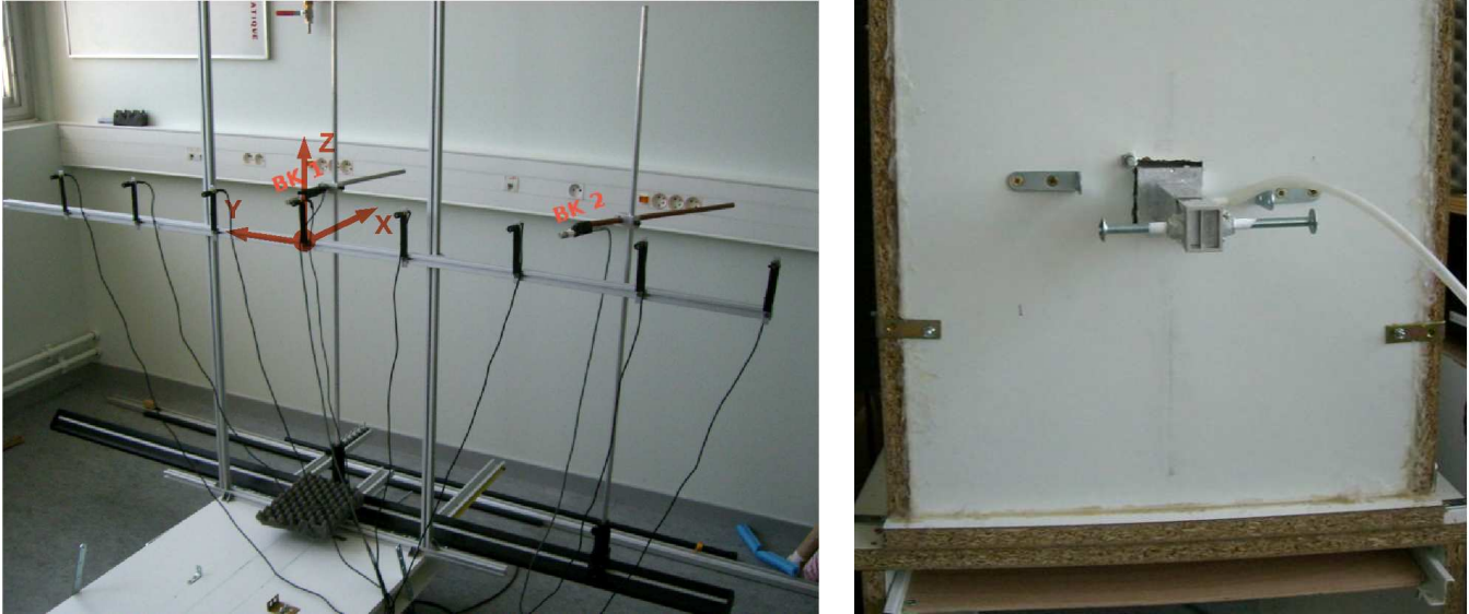
FIGURE 5.3 – Photographies de l’antenne de microphones placée sur le banc expérimental (à gauche) et de la maquette du conduit vocal montée sur le réservoir de pression lors des mesures acoustiques (à droite).
