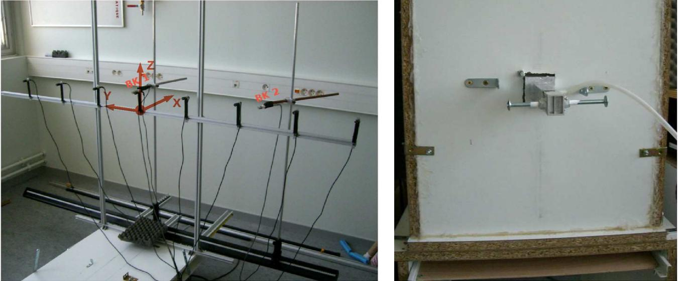
**FIGURE 5.3** – Photographies de l’antenne de microphones placée sur le banc expérimental (à gauche) et de la maquette du conduit vocal montée sur le réservoir de pression lors des mesures acoustiques (à droite).
