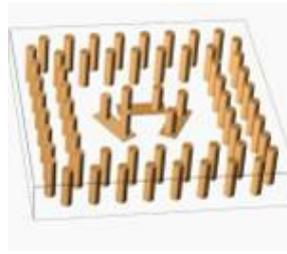
Figure I-19 : filtre d'ordre 3 réalisé en *LTCC* [I.39]
