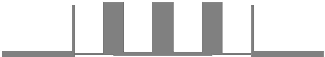
**Figure I-8 : masque d'un filtre d'ordre 5 à stubs**
