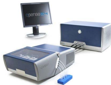
Figure 24. Image du système Quartz Crystal Microbalance – Dissipation (Q-SENSE E4). Ce système permet de faire des études comparatives de cinétiques de greffage biomoléculaire (sensibilité de l'ordre de 20 \text{ ng/cm}^2 ). Il contient 4 cellules fluidiques qui peuvent être utilisées en série ou en parallèle pour s'adapter à une large variété de protocoles expérimentaux.
