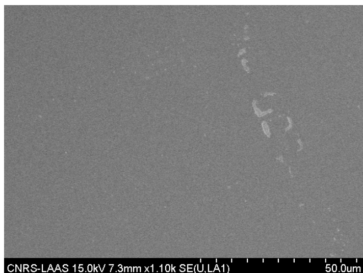
Figure 19. Image MEB de contrôle. Substrat SERS recouvert d'une couche d'or de 100 nm d'épaisseur : uniquement les agrégats de taille importante sont visibles.
