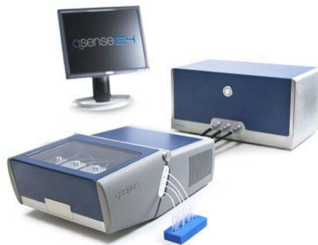
Figure 24. Image du système Quartz Crystal Microbalance – Dissipation (Q-SENSE E4). Ce système permet de faire des études comparatives de cinétiques de greffage biomoléculaire (sensibilité de l'ordre de 20 ng/cm 2 ). Il contient 4 cellules fluidiques qui peuvent être utilisées en série ou en parallèle pour s'adapter à une large variété de protocoles expérimentaux.
