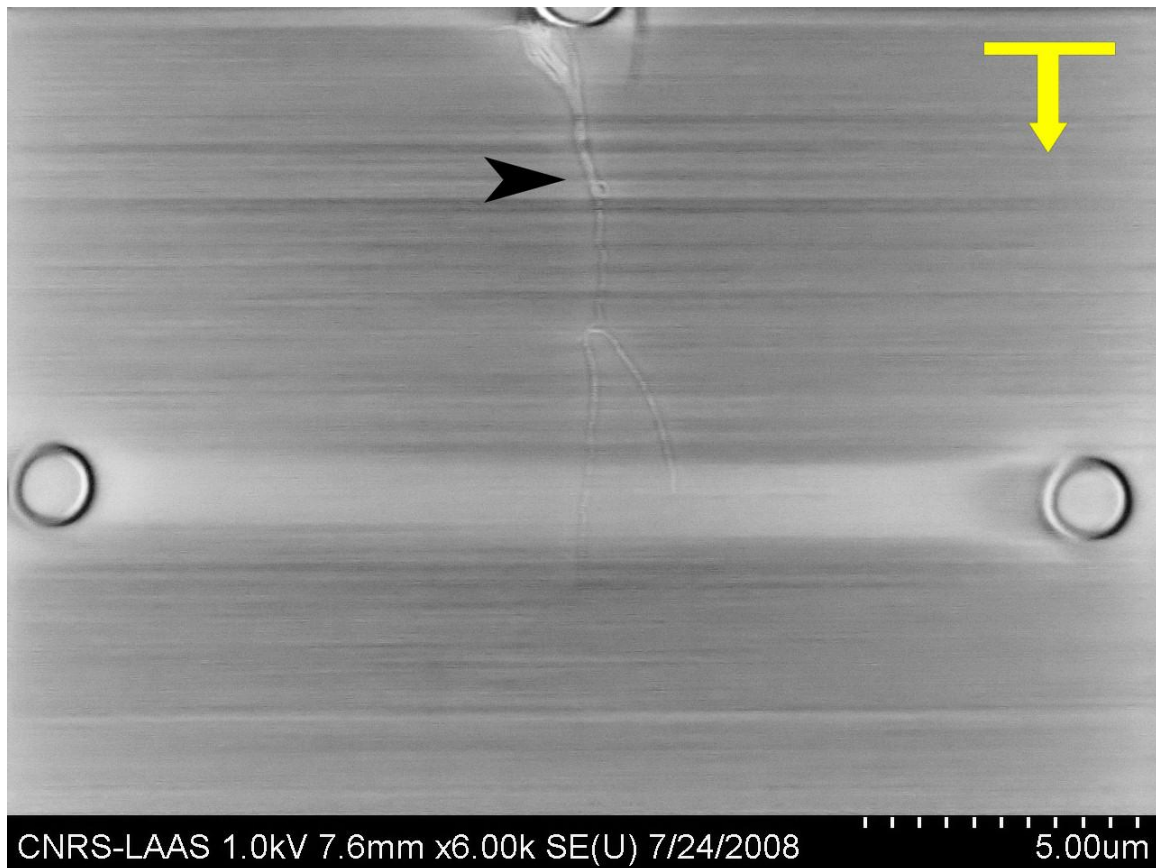
Figure III.20 : Image de MEB d'un dépôt d'une suspension de NTC dans la NMP, réalisé à 100nm/s sur un timbre de PDMS avec des motifs circulaires en creux de 870nm de profondeur.
