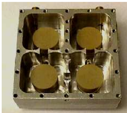
Figure I.19 : Filtre à résonateur diélectrique d'ordre 4
