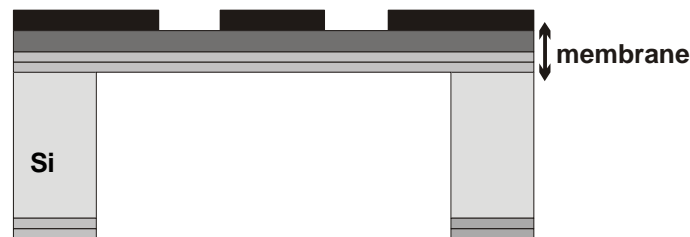
Figure II.10. Topologie de la ligne CPW sur membrane
