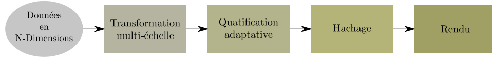
FIGURE 6.1: Vue d’ensemble de la méthode de hachage de coefficients d’ondelettes. A partir, de données en N-Dimensions (texture, SVBRDF , BTF ), le dispositif transforme et compresse les données d’origine en une représentation compacte compatible pour un rendu temps-réel sur le matériel graphique actuel.
