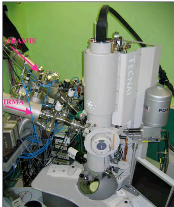
**Figure VII.19 :** Plateforme JANNuS –Orsay : MET en double faisceaux in-situ. Les arrivées d'ions sont fléchées en rouge. Les ions  $\geq \text{MeV}$  sont fournis par l'accélérateur ARAMIS. Les ions de moyenne énergie (seuls utilisés dans cette expérience) sont obtenus à partir de l'implanteur IRMA.
