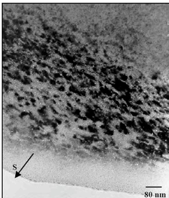
**Figure II.13 :** Coupe transverse d'un échantillon implanté à  $T$  ambiante avec des ions hélium de 50 keV à une dose de  $5 \cdot 10^{16} \text{ He/cm}^2$ , image en champ clair [David et al. 2001]. Ce champ clair de la zone endommagée montre, en plus de la présence de nombreuses boucles de dislocation (contraste noir), des bulles de 2-3 nm, imagées en champ clair sous focalisé (contraste blanc).
