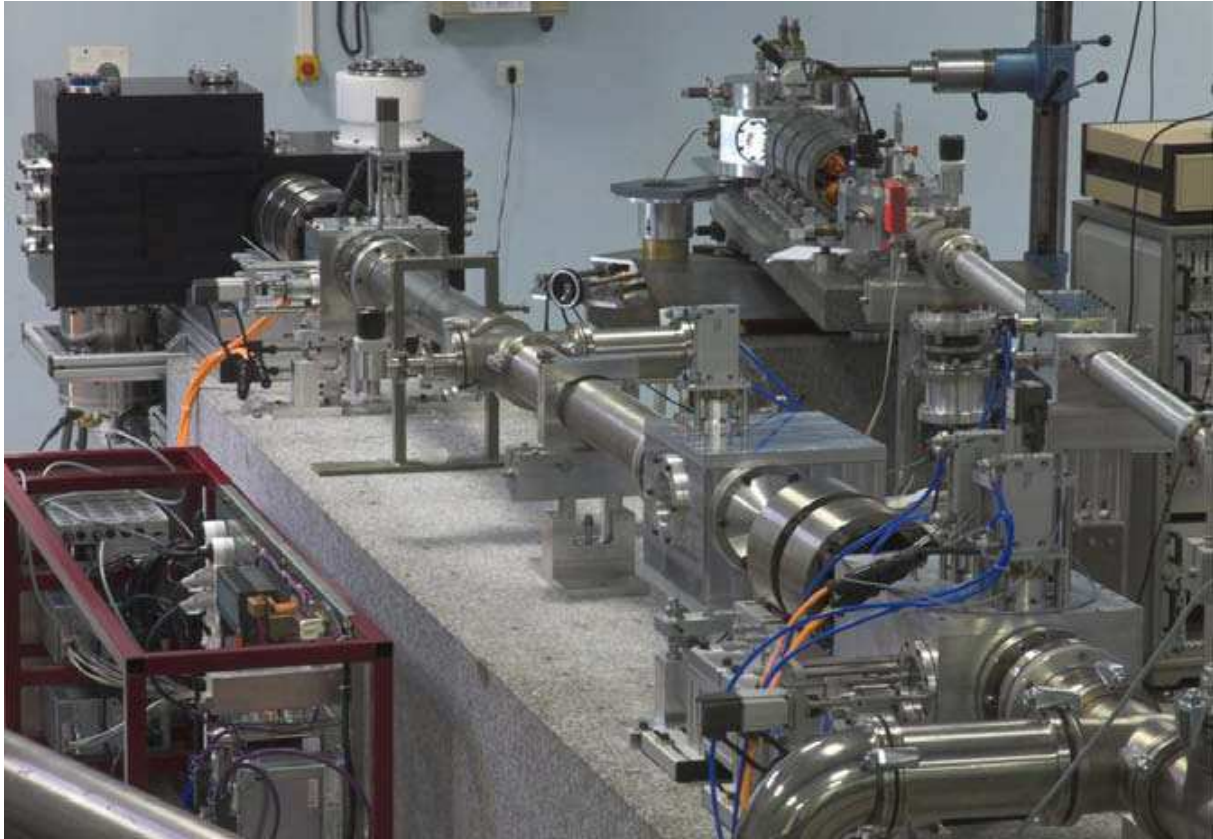
Figure 30 : La ligne nanofaisceau du CENBG et la chambre d'analyse. A gauche, nouvelle ligne nanofaisceau. A droite, ligne microfaisceau actuelle.
