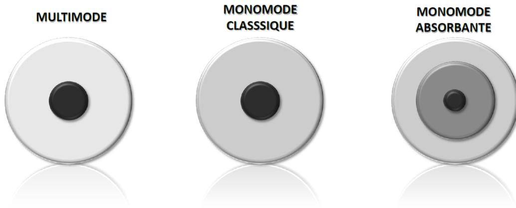
FIGURE 5.7 – Schéma transverse des trois fibres testées dans cette thèse.
