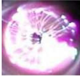
Figure 30 – Photographie de la décharge en régime filamentaire.
