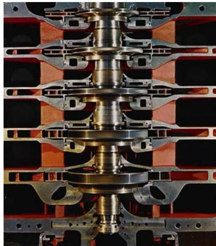
Figure I-6. Compresseurs à flux radial (multi-étages)
