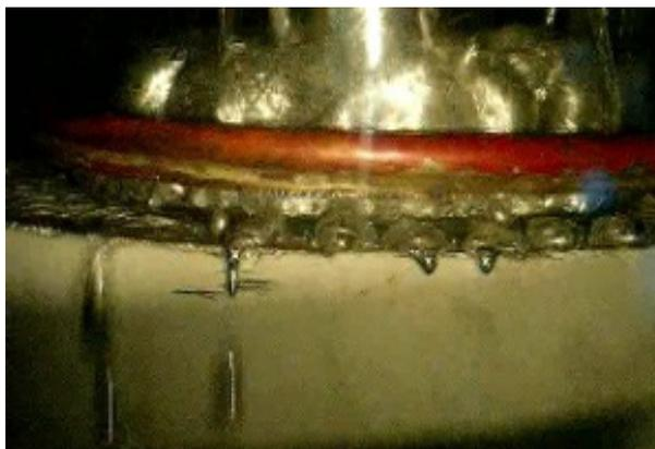
Figure 4-3 : I autour de 1700-1900A ; instabilités de surface. Rétention électromagnétique partielle.
