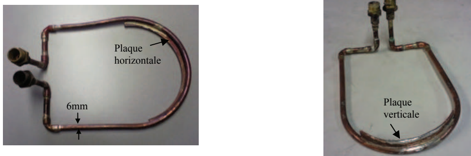
Figure 4-2 : Inducteur mi-circulaire avec plaque concentratrice de courant à l'avant.
