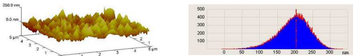
Figure 2.8 : Etude de la rugosité par AFM du lot modérément dopé 1
