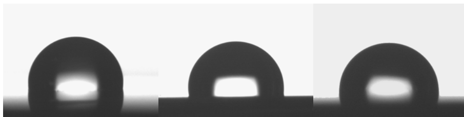
Figure 2.16 : Lot modérément dopé 1 - Angle de contact: \sim 90^\circ
