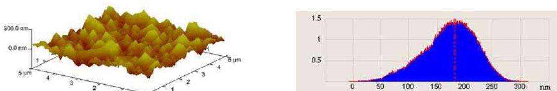
Figure 2.10 : Etude de la rugosité par AFM du lot fortement dopé 2
