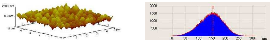
Figure 2.9 : Etude de la rugosité par AFM du lot fortement dopé 1
