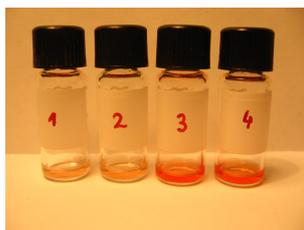
FIGURE 3.60 – Photo des 4 solutions composites dans les 2 solvants cétone et toluène faiblement concentrées (1) PMMA(MEC)/QDs(tol) 10/1, (2) PMMA(MiBC)/QDs(tol) 10/1, et fortement concentrées (3) PMMA(MEC)/QDs(tol) 1/1, (4) PMMA(MiBC)/QDs(tol) 1/1
