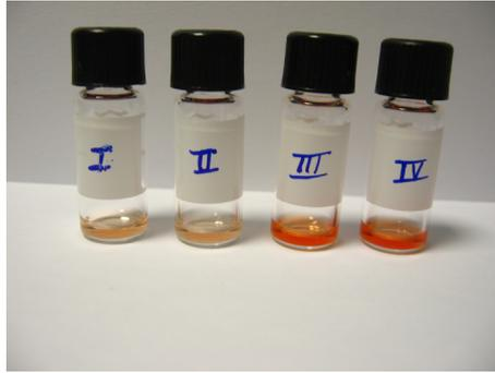
FIGURE 3.88 – Photo des 4 solutions composites PMMA-QDs (I, II, III, IV) (Cf. Tab. 3.24 ayant servi à la réalisation des films sur carbone vitreux pour les mesures RBS
