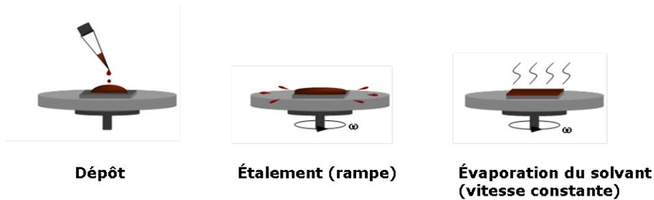
FIGURE 2.36 – Schéma du processus de spin coating
