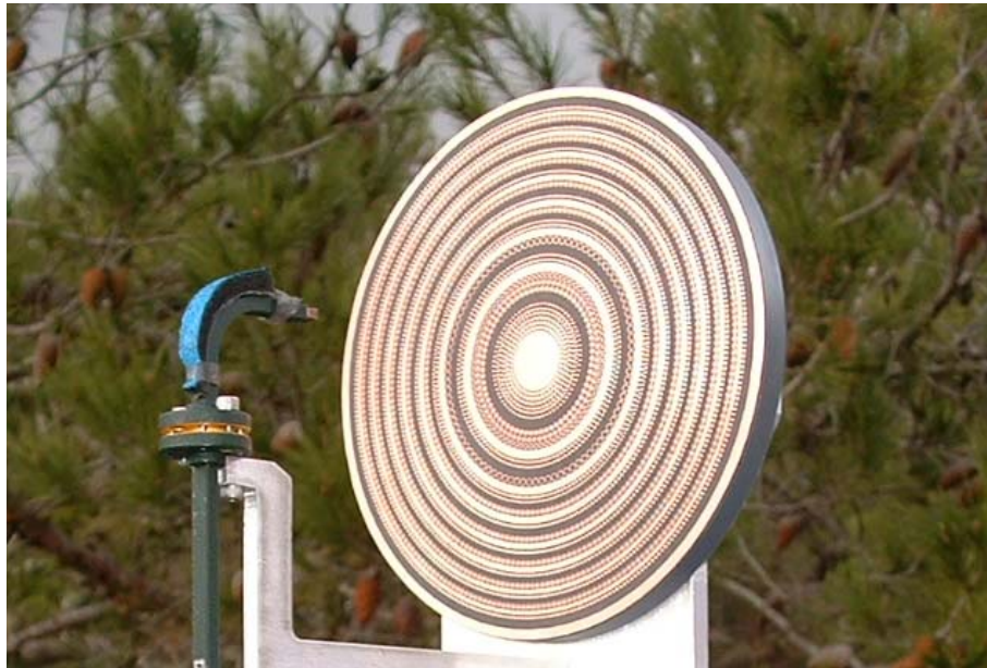
Figure 1.38: photo du réflecteur de Fresnel 8 et 4 zones diamètre 135 mm, \epsilon_r = 2,2 d'épaisseur 508 \mu\text{m} , f/D=0,5
