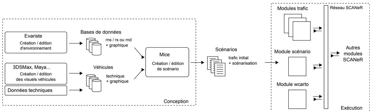
FIGURE 4.8 – Chaîne de conception et d'exécution des scénarios.
