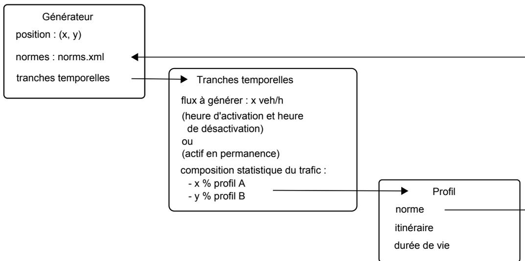
FIGURE 4.16 – Fonctionnement des générateurs de trafic.
