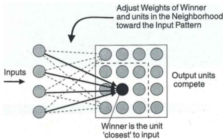
FIGURE 3.2 – Exemple de structure d'un réseau de Kohonen.
