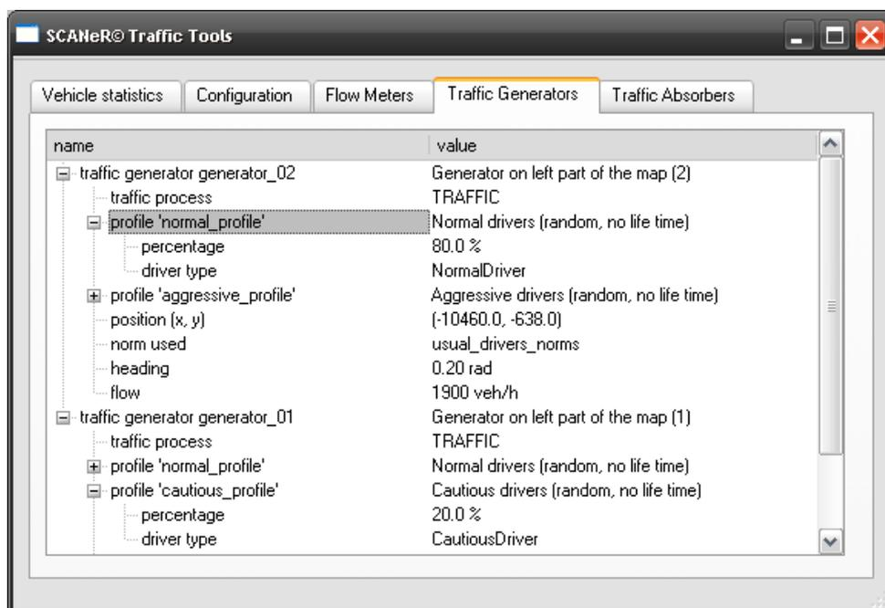
FIGURE 4.18 – Les informations relatives aux générateurs de trafic dans le module « Traffic Tools ».
