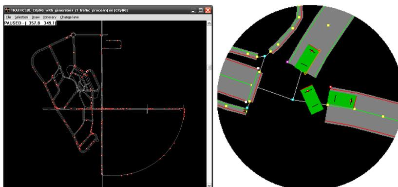
FIGURE 4.6 – Rendu visuel 2D du trafic routier avec le module `wcarto` : à gauche une vue globale d'une simulation sur réseau urbain (les points rouges sont les véhicules), à droite la vue détaillée d'une intersection.
