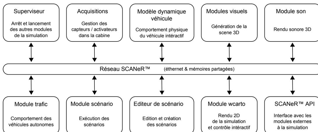
FIGURE 4.3 – Architecture de SCANeR™ : les différents modules peuvent être exécutés sur des machines différentes et communiquent à travers le réseau ou des mémoires partagées.
