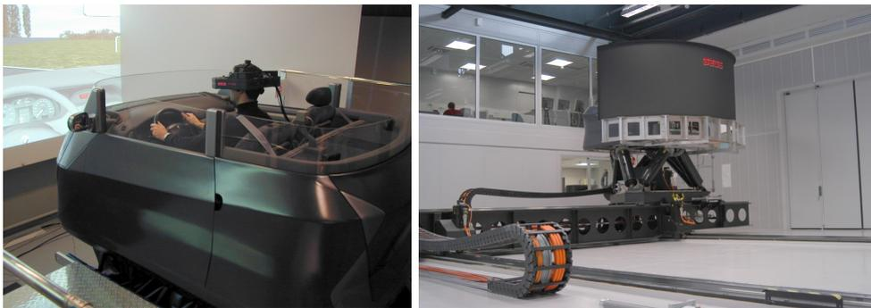
FIGURE 4.2 – A gauche le simulateur CARDS<sup>©</sup> 2 couplé à un casque de réalité virtuelle, utilisé pour des tests d'ergonomie en situation de conduite. A droite le simulateur Ultimate, qui utilise une plateforme mobile à vérins 6 axes montée sur deux rails  $X \cdot Y$ .
