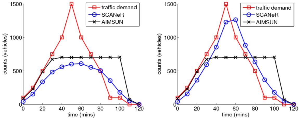
FIGURE 5.6 – Comparaison des flux mesurés avec SCANeR™ et AIMSUN par rapport à la demande, avec deux paramétrages différents pour les normes.
