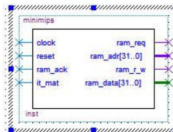
FIGURE 4.5 – Schéma bloc de miniMIPS
