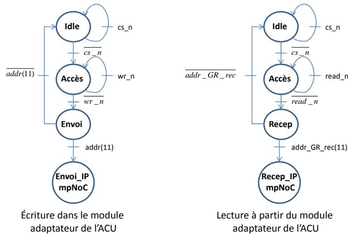
FIGURE 4.17 – FSM de l'adaptateur de l'ACU
