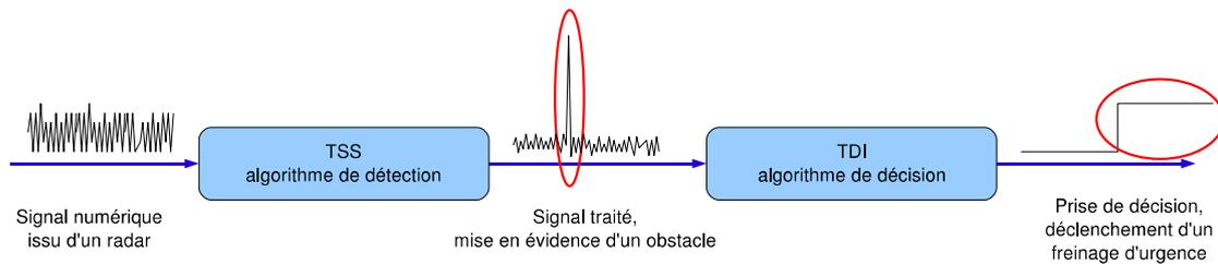
FIGURE 2.2 – Représentation de l'application radar anti-collision
