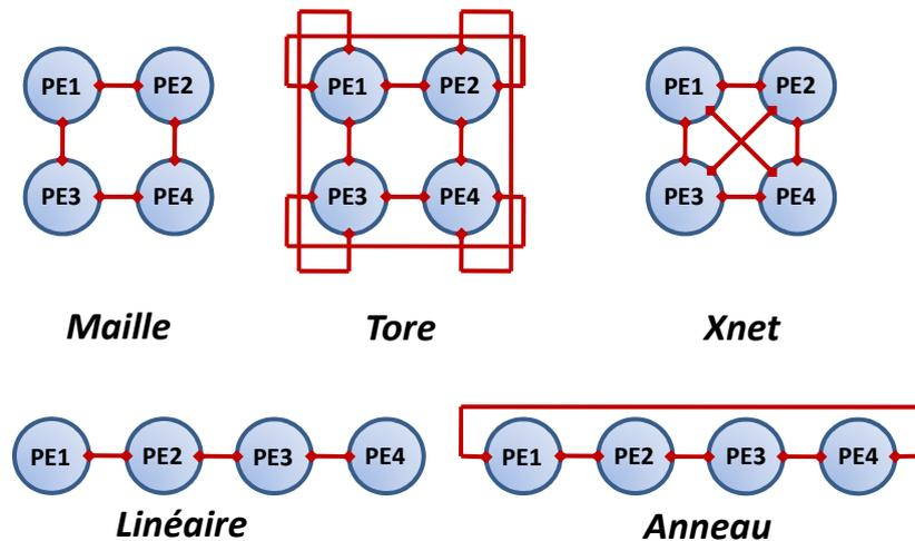
FIGURE 3.4 – Topologies du réseau de voisinage
