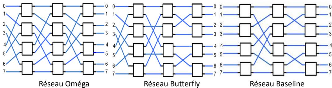
FIGURE 4.27 – Types de réseaux Delta (8,8)
