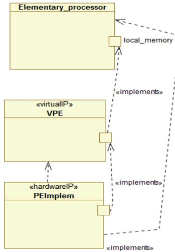
FIGURE 5.29 – Déploiement d'un IP pour le PE
