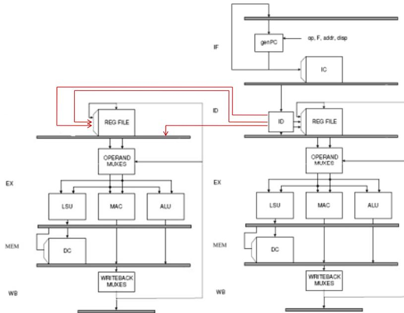
FIGURE 4.12 – Réduction du pipeline de l'OpenRISC
