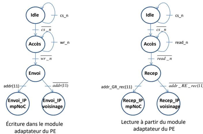
FIGURE 4.18 – FSM de l'adaptateur du PE
