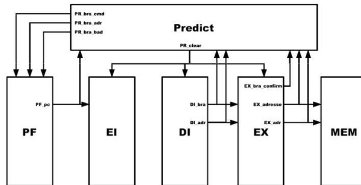
FIGURE 4.9 – Connexion du module prédicteur de branchement
