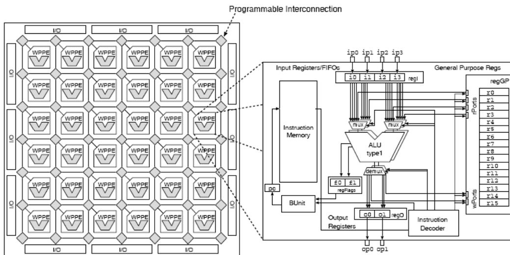
FIGURE 2.8 – Architecture WPPA et structure d'un WPPE [57]
