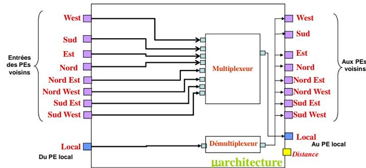
FIGURE 4.19 – Architecture du routeur de voisinage
