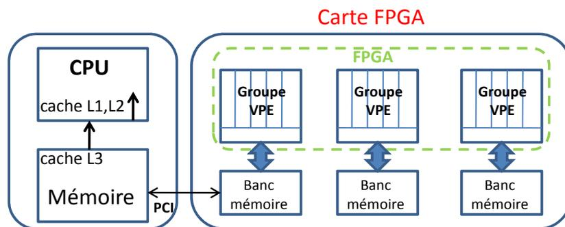
FIGURE 2.5 – Architecture du coprocesseur lié au processeur hôte
