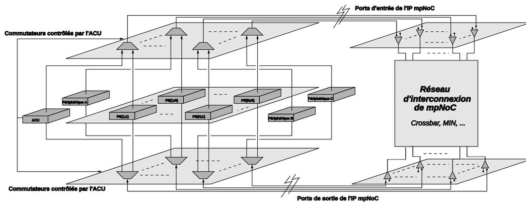
FIGURE 4.23 – Intégration de mpNoC dans mppSoC
