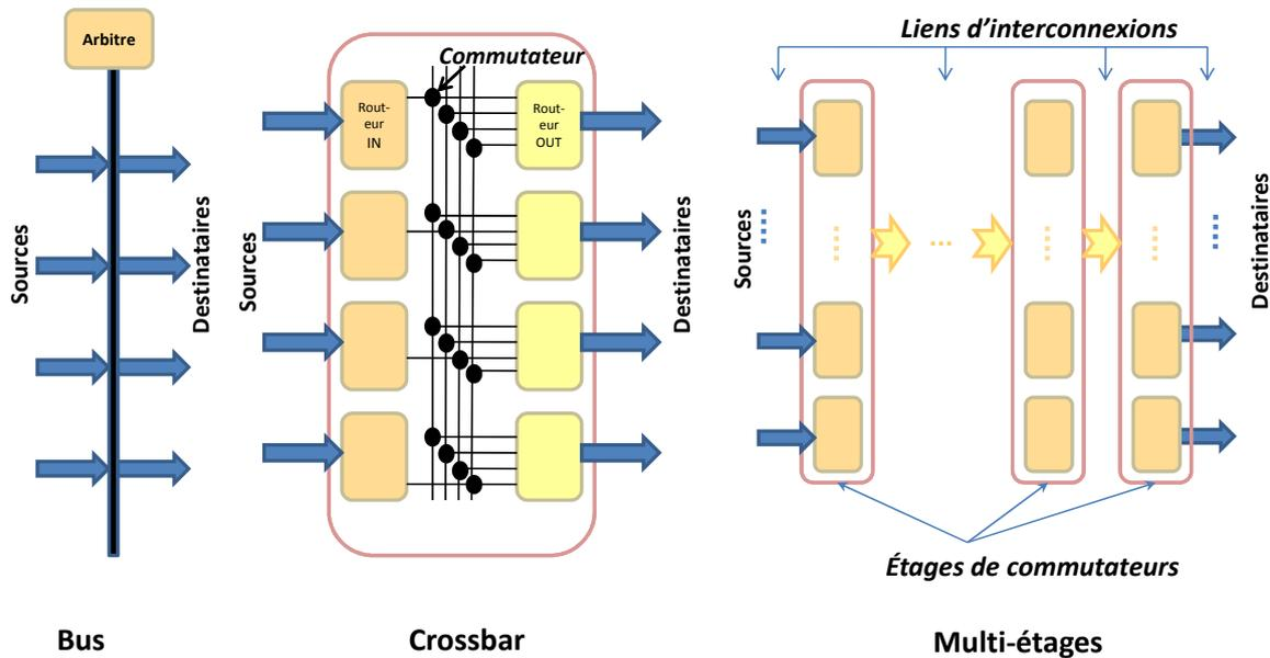
FIGURE 3.5 – Types de réseaux d'interconnexion du mpNoC
