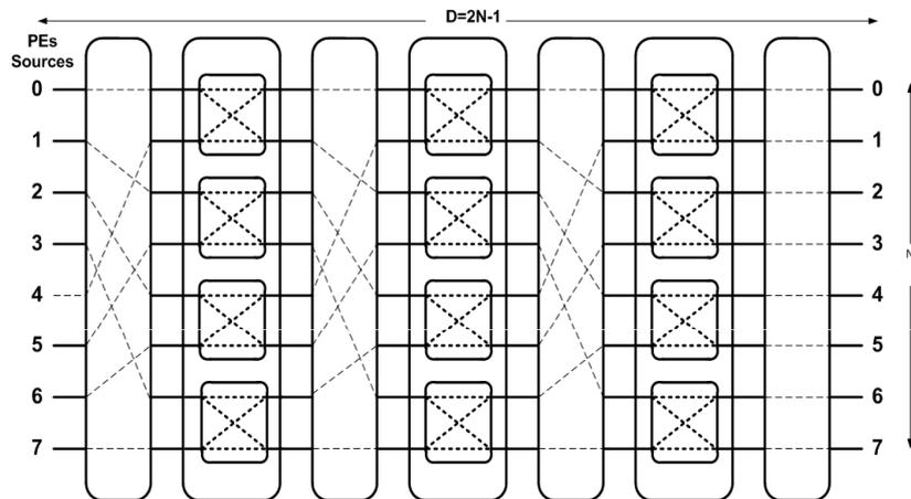
FIGURE 3.7 – Structure de commutateurs formant un réseau MIN-oméga
