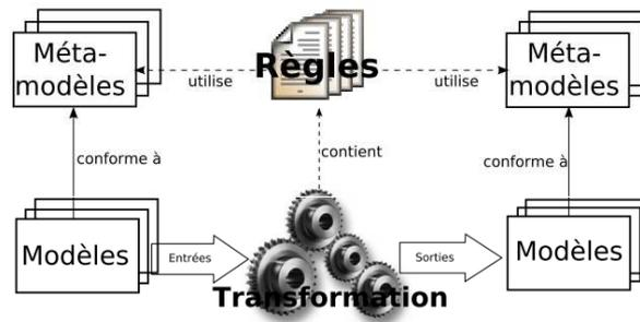
FIGURE 5.2 – Principe de transformation de modèle
