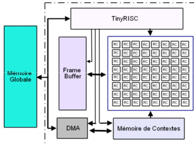
FIGURE 2.7 – Architecture bloc de Morphosys (M2)
