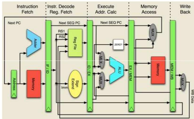
FIGURE 4.4 – Pipeline miniMIPS à 5 étages
