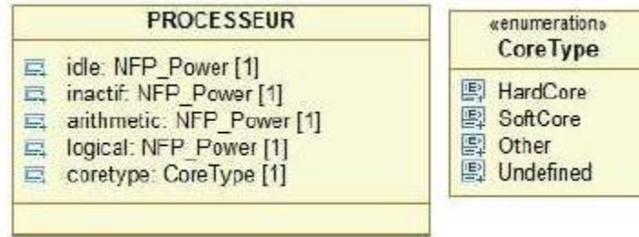
Figure 2.5 : Le modèle du processeur proposé
